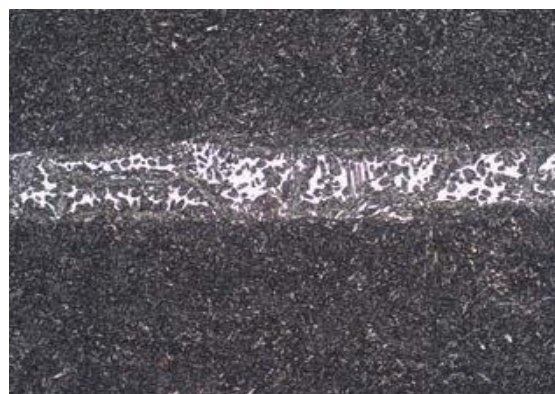
Слика 2- Структура мартензитног нерђајућег челика [24]
