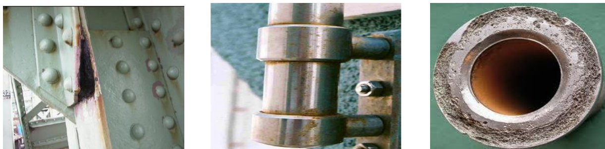
Слика 16- Примери корозије у зазорима [10]
