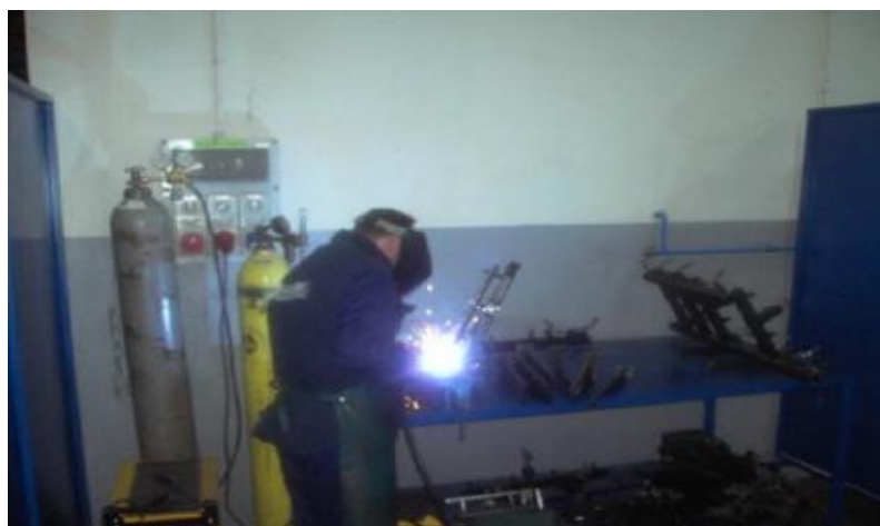
Слика 34-Заваривање нерђајућег челика TIG поступком [14]
