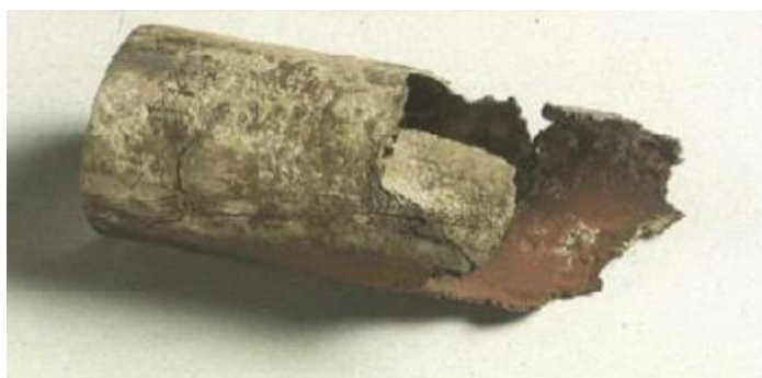
Слика 19 - Напонска корозија нерђајућег челика [31]
