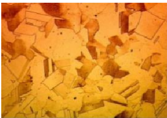
Слика 6- Типичне микроструктуре нерђајућих челика [26]
