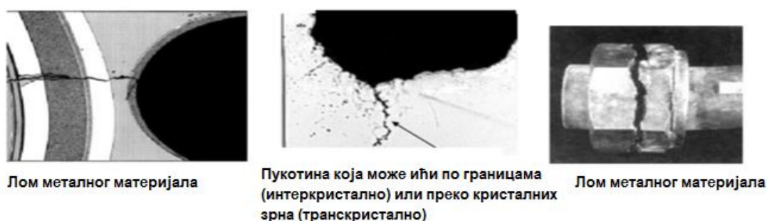
Слика 21– Последица напонске корозије [10]
