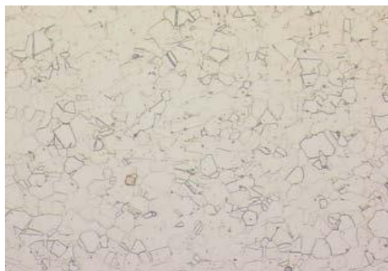
Слика 9 – Микроструктура Cr- Ni нерђајућег челика са карбидима по граници зрна аустенита[29]
