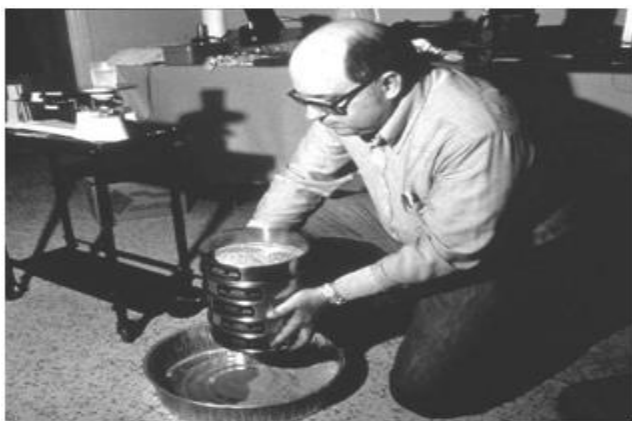
Слика 10: Упоредба величине честица и расподелу абразива са подацима добијеним од стране снабдевача абразива.
