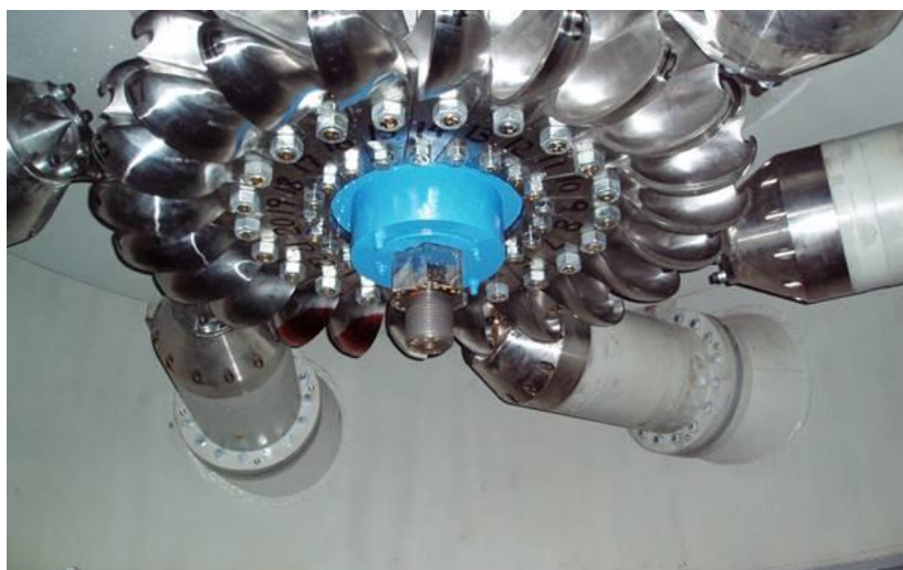
Слика 3.14: Вертикална Пелтонова турбина[20]
