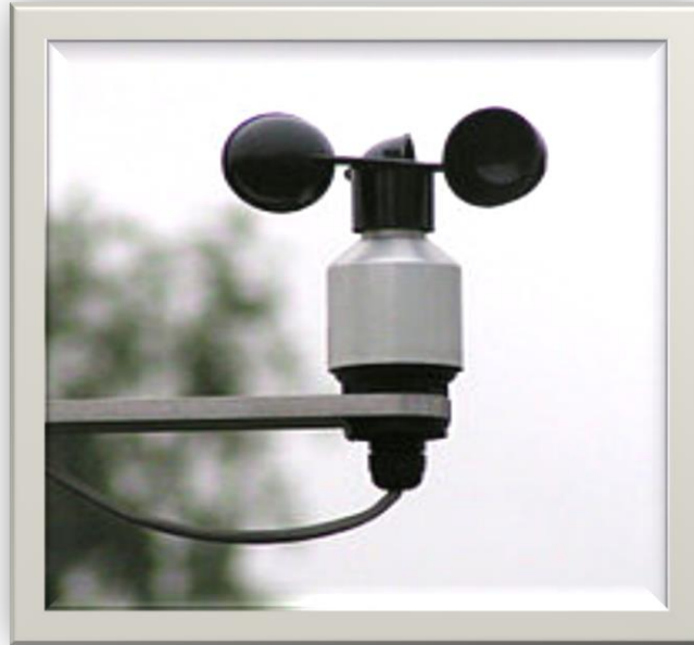
Слика 9: Анемометар, једноставна ветрењача са вертикалним вратилом 16
