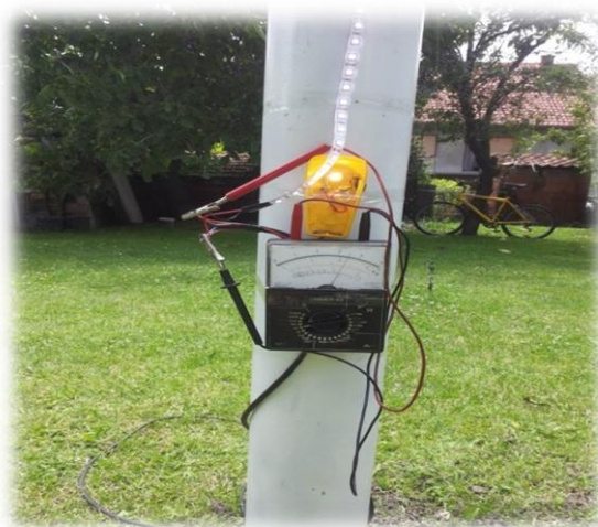
Слика 31: Тестирање рада траке са LED диодама
