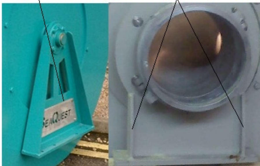
Слика 24. Укрућења на ослонцима
