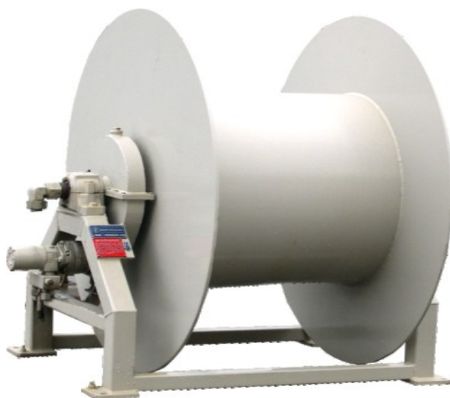
Слика 14. Хидраулички покретано витло за намотавање еластичног црева[7]
