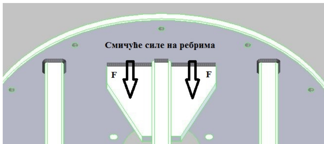
Слика 58. Дејство смичућих сила на бочне странице ребра
