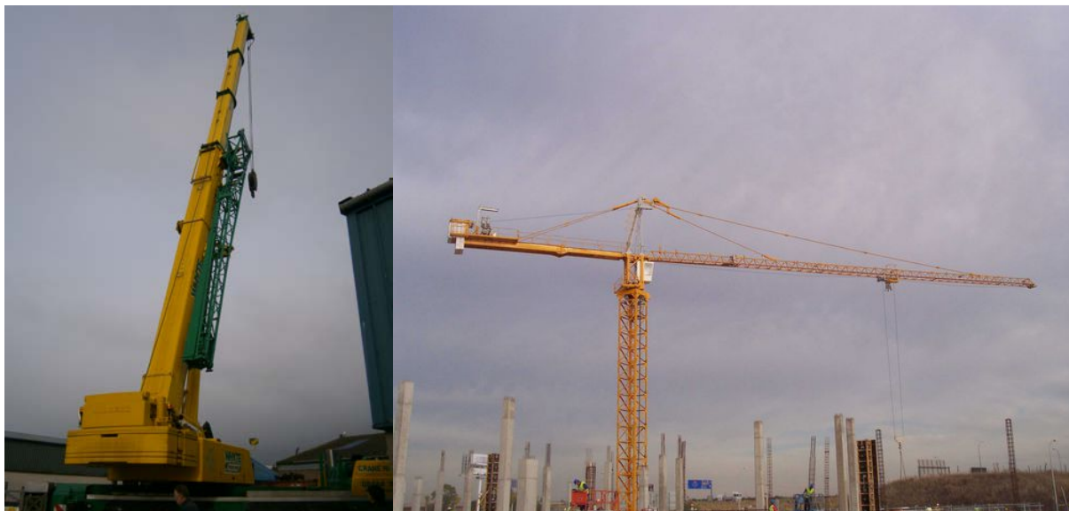
Слика 4. Лево: аутодизалица са телескопским краном; десно: торањски кран
