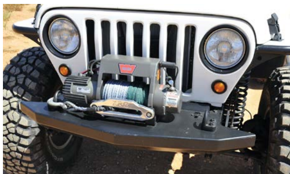
Слика 7. Пример витла које се налази на теренским возилима
