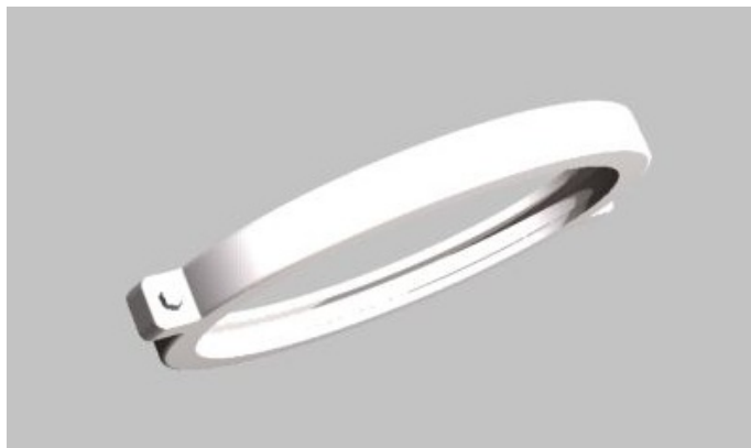
Слика 30. Копча спојена завртњевима
