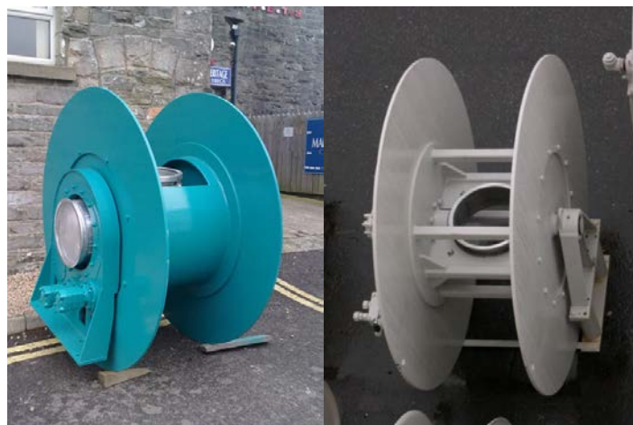
Слика 20. Изглед добоша као шупљег ваљка са стандардним профилним носачима [7],[11]
