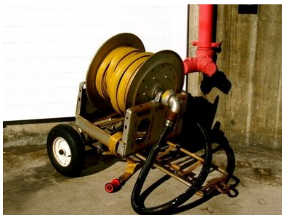
Слика 13. Витла за намотавање еластичног црева (баштенско и ватрогасно црево)
