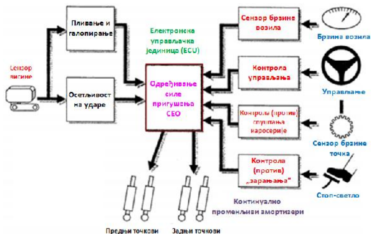
Слика 6.5. : Компјутерски контролисан променљиви степен пригушења – улази и излази
