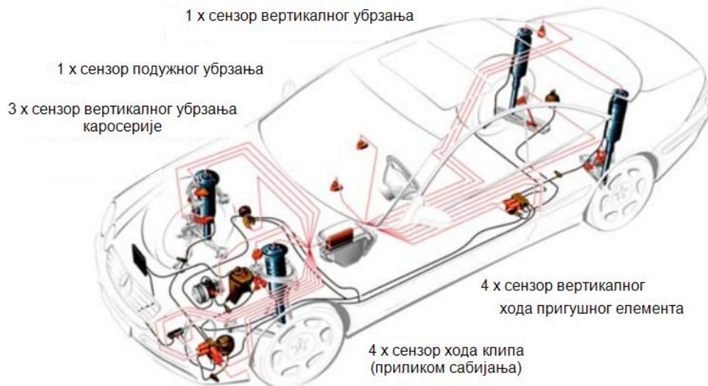
Слика 3.5. : ABC систем активног еластичног ослањања на моделу DaimlerChrysler [12]
