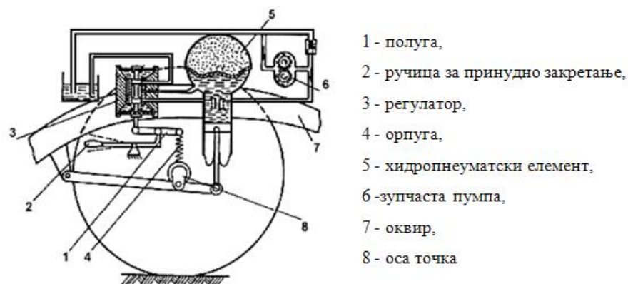
Слика 2.28. : Регулатор хидропнеуматског система еластичног ослањања
