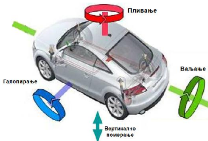
Слика 2.1. : Динамичке појаве при кретању возила
