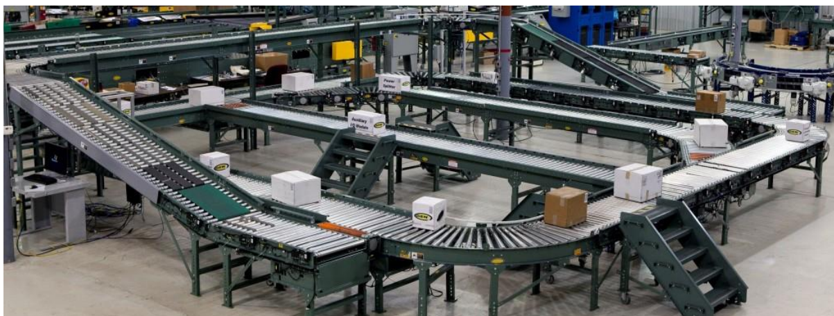
Слика 23. Систем транспорта коадних терета у чијем саставу су претежно ваљкасти транспортери, [23]
