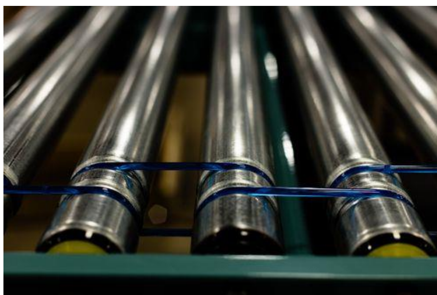
Слика 35. Ваљкасти транспортер са уретанским тракама које повезују сваки наредни ваљак, [27]
