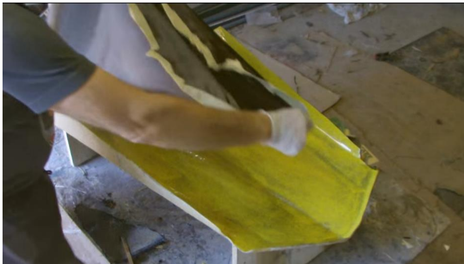
Слика 37. Постављање првог слоја угљеничних влакана
