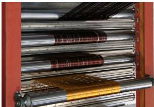
Слика 5. Пролаз ПАН влакана кроз оксидациону пећ
