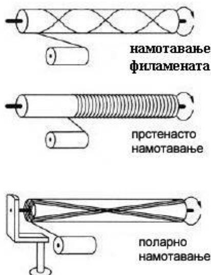
Слика 6. Приказ намотавања филамената, прстенастог (ободног) и поларног намотавања
