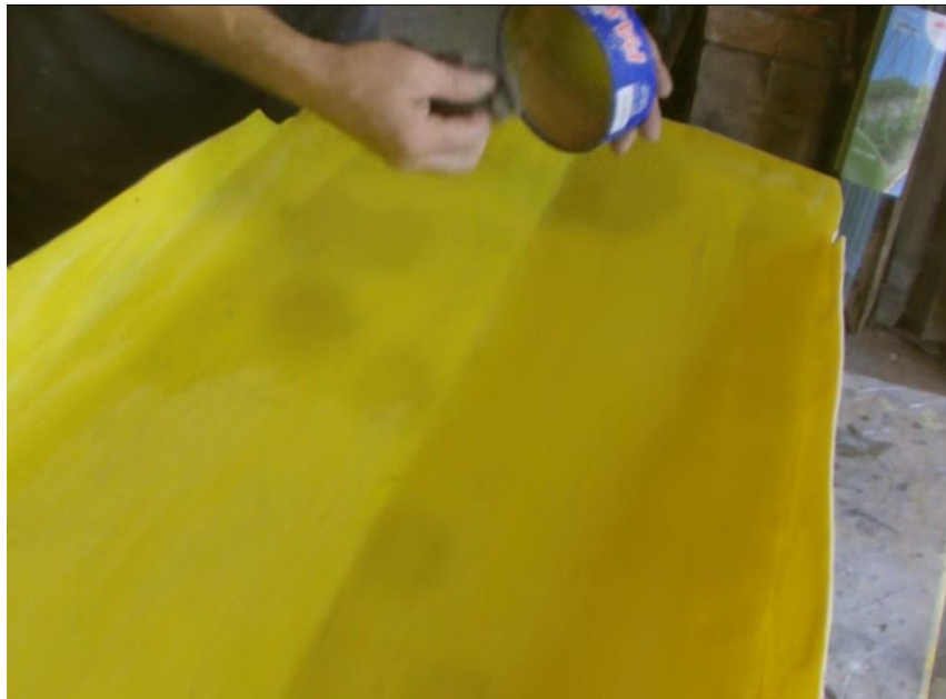
Слика 35. Наношење одвајача на калуп
