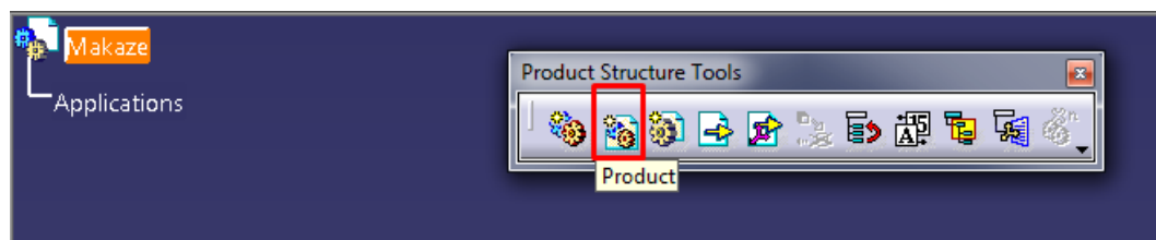
Слика 27 Начин израде подсклопа
