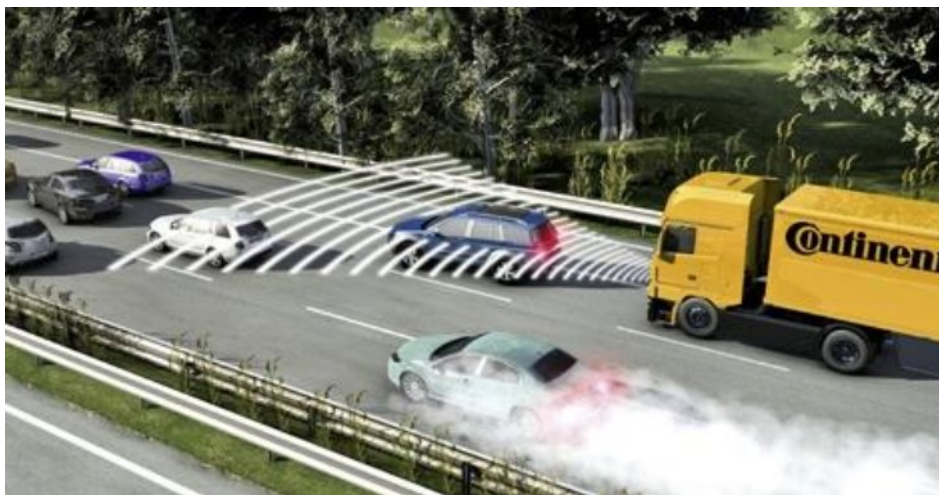
Слика 29. Приказ рада система аутоматске контроле растојања, [11]
