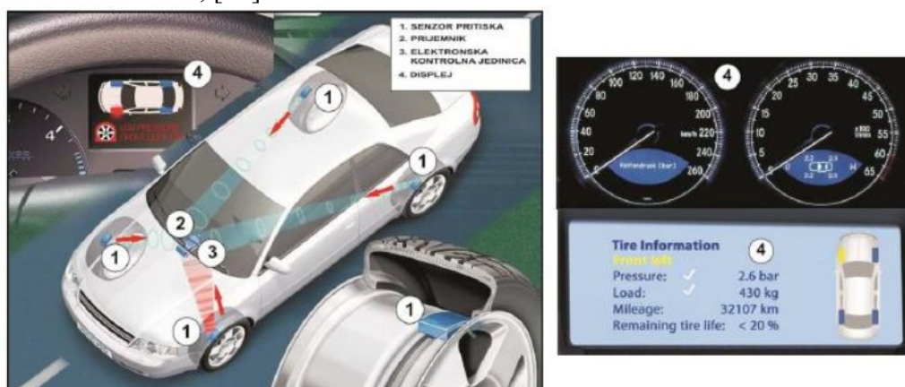
Слика 28. Основни елементи TPMS система, [16]
