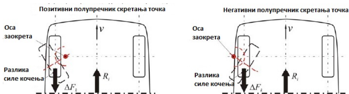
Слика 3.4. Предност негативног положаја осовинице точка приликом кочења [4]
