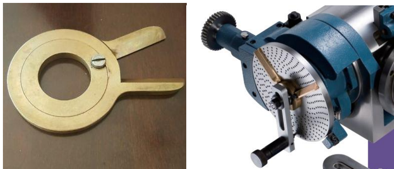
Слика 11. – Разделник и његов положај на подеоном апарату
