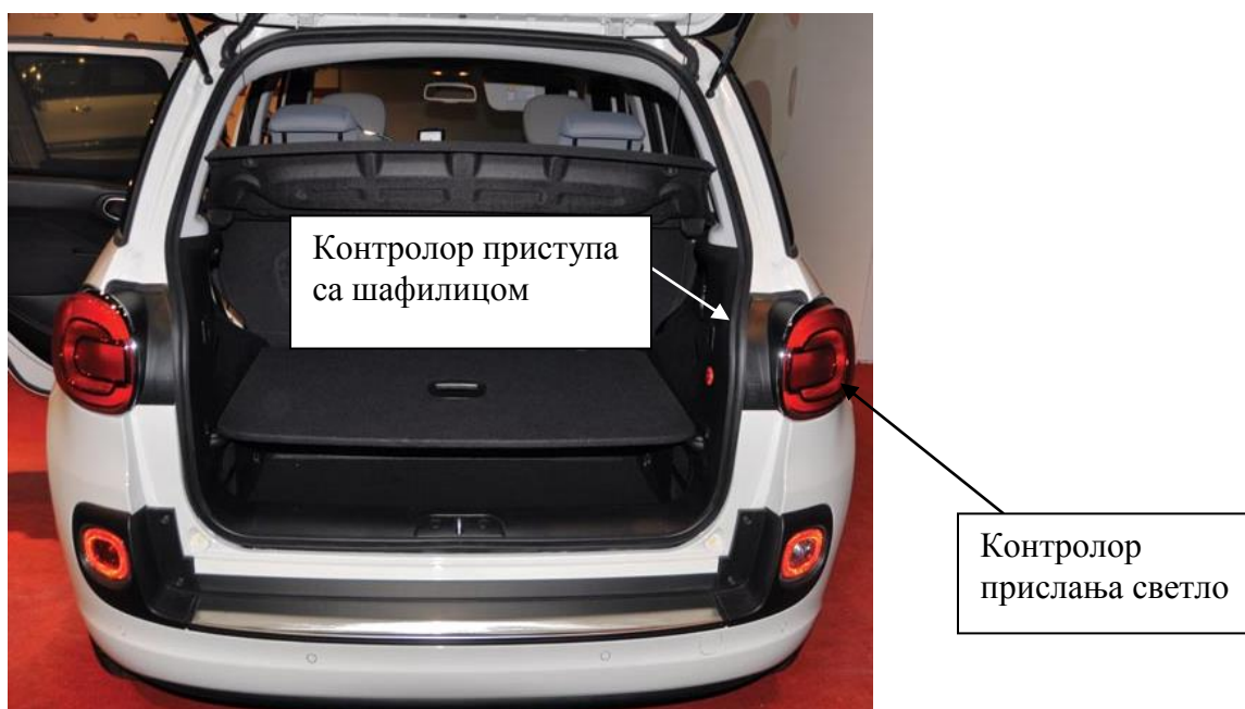
Сл. 30 Поступак монтирања и провере задњих светла [10]
