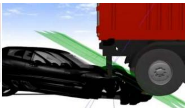
Слика 31. Контактна раван под углом [4]
