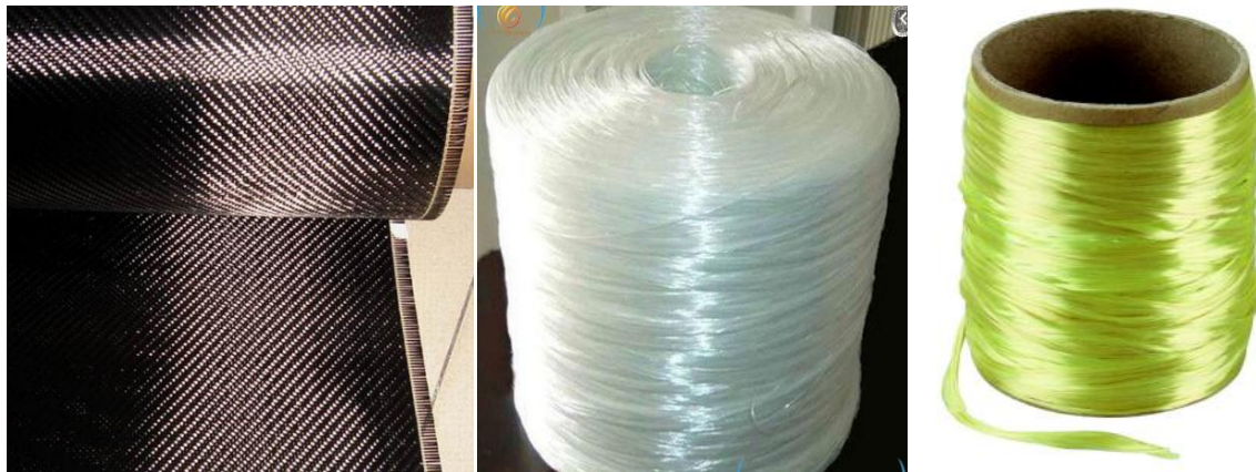
Слика 3.2. Карбонска, стаклена и арамидна влакна [12],[13]
