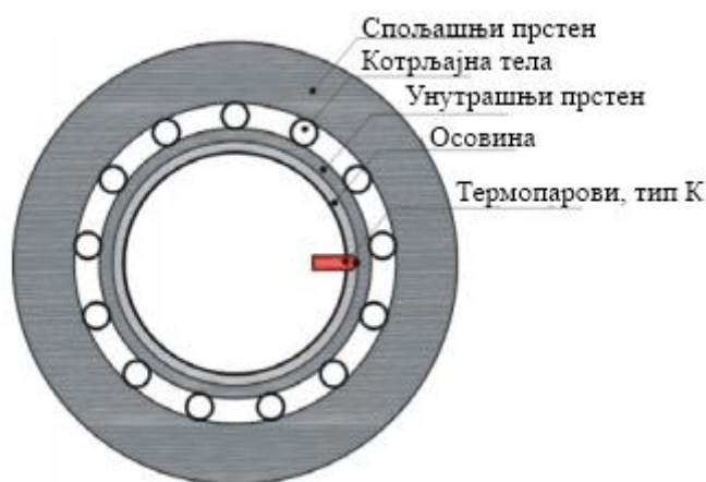
Слика 4.13. Шематски приказ термопарова при мерењу температуре на унутрашњем прстену лежаја точка [16]
