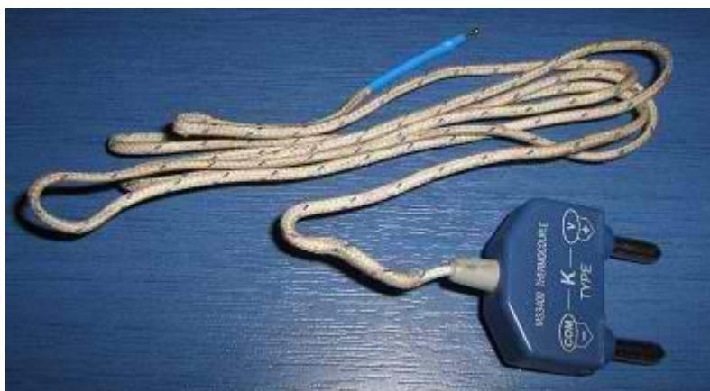
Слика 2.10. Изотермални блок код термопара К типа за мерење температуре помоћу мултиметра [5]
