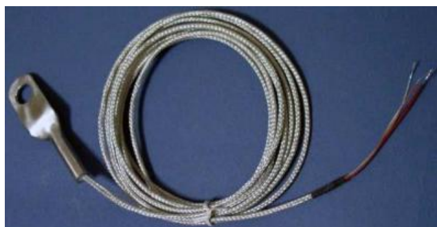
Слика 4.9. Термопар Pt100 RTD за мерење температуре уља мотора СУС [16]
