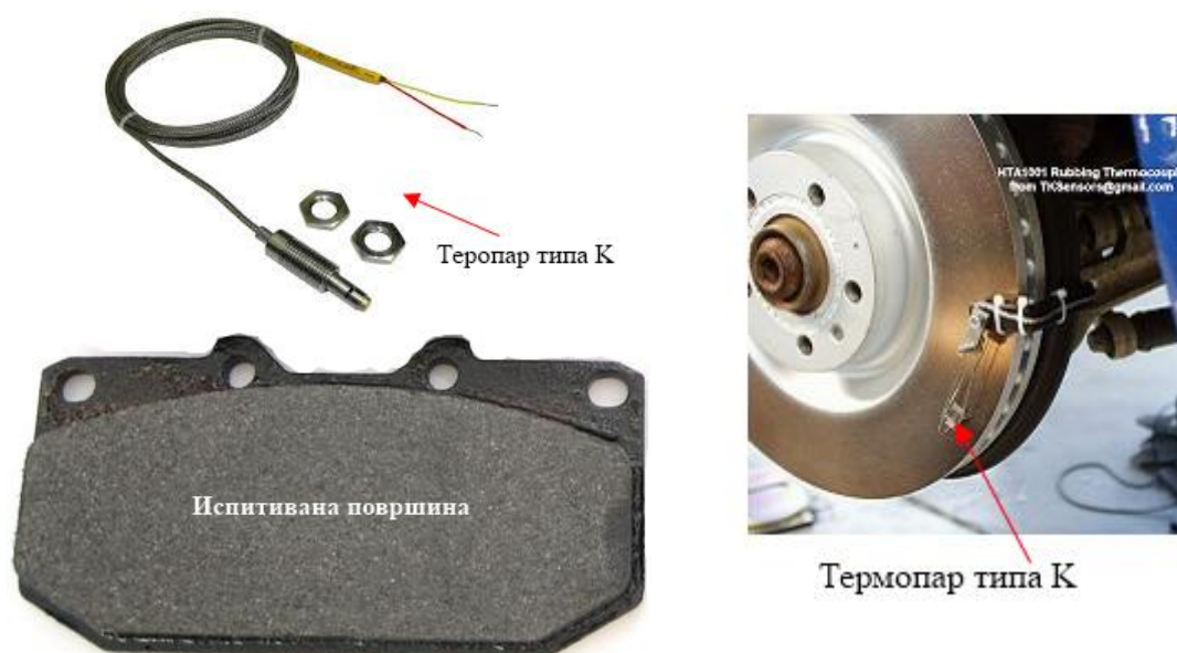
Слика 4.15. Мерење температуре диск кочнице термопаром типа К [17]
