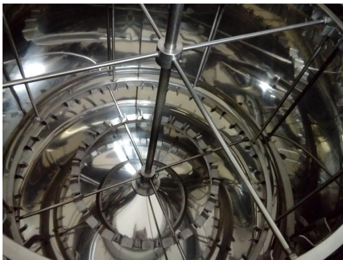
Слика 29. – Унутрашњост радијалне врцаљке (B3)
