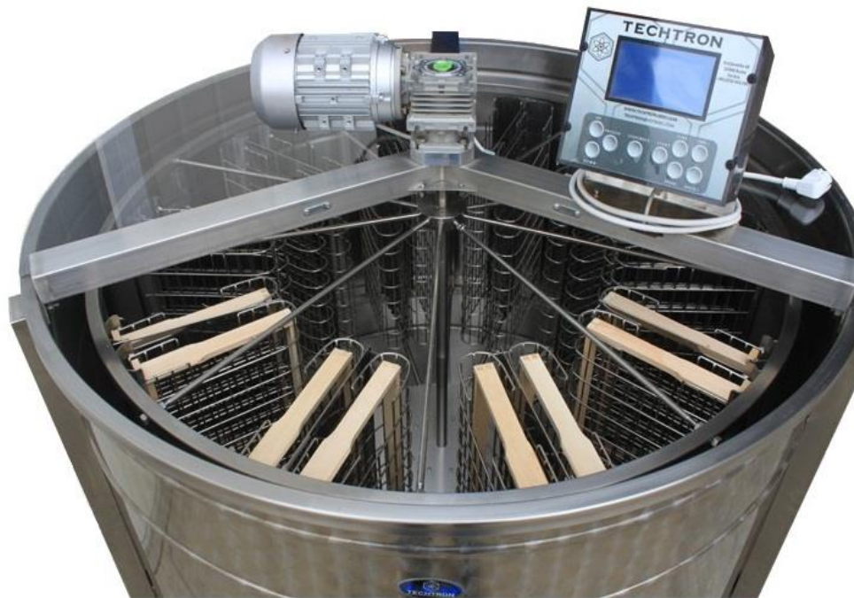
Слика 33. – Касетна аутоматска врцаљка са дуплим касетама
