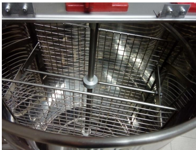
Слика 25. – Тангенцијална врцаљка у коју може да стане два рама (B1)
