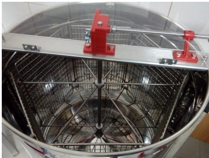
Слика 24. – Тангенцијална врцаљка у коју може да стане шест рамова
