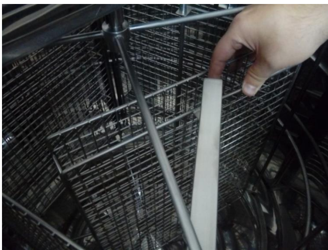
Слика 30. – Касетна врцаљка у којој се касете са рамовима окрећу ручно
