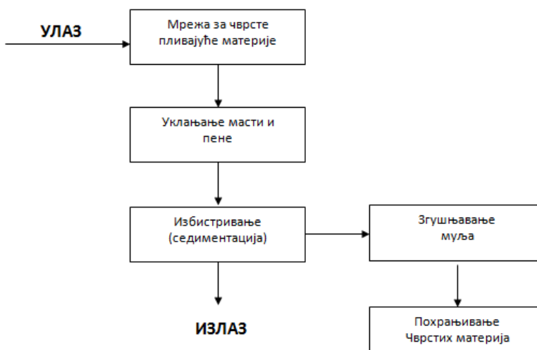
Слика 13. Упростијена шема примарног пречишћавања отпадних вода [1]
