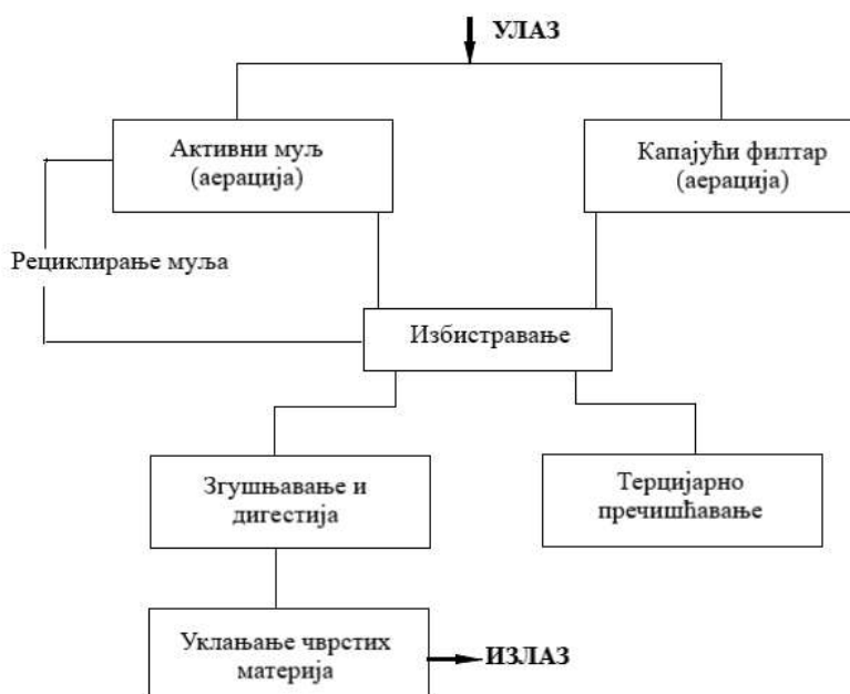
Слика 2.3 Упростирана шема примарног пречишћавања отпадних вода, [1]
