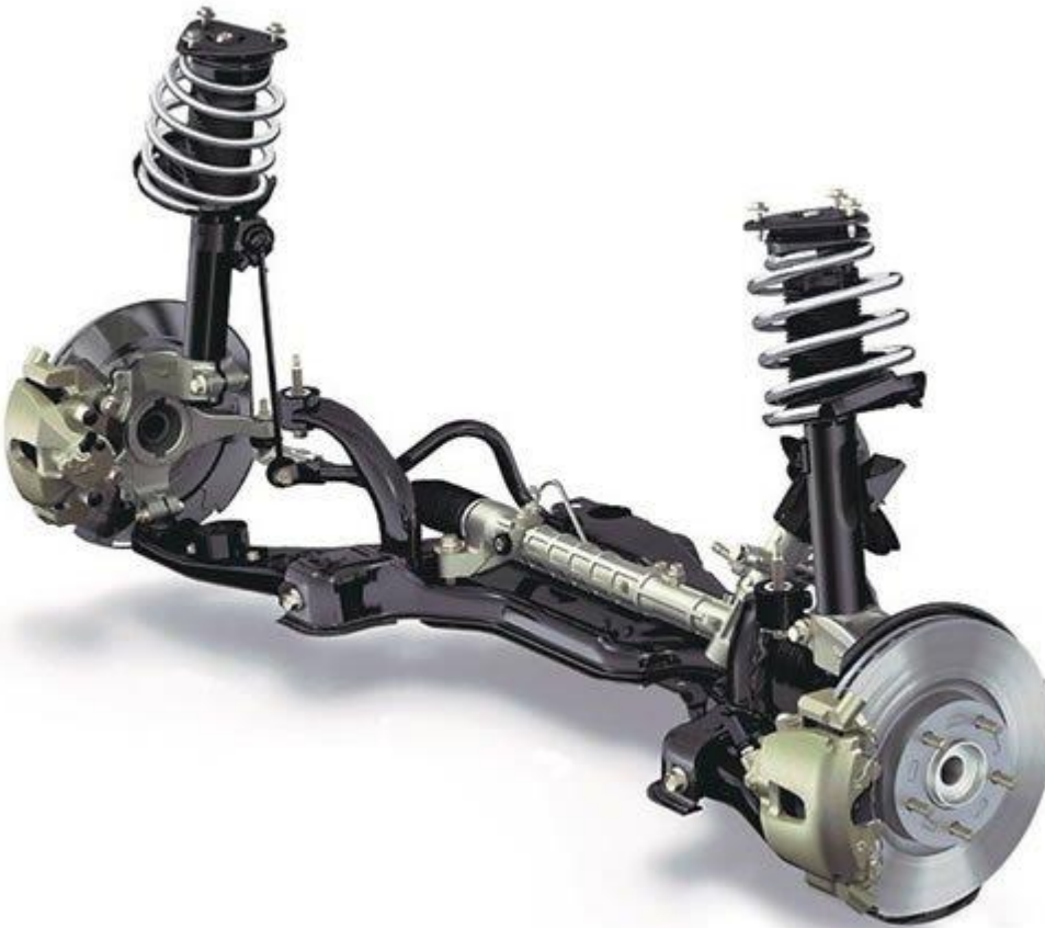
Слика 3.8. : Систем еластичног ослањања типа McPherson [9]
