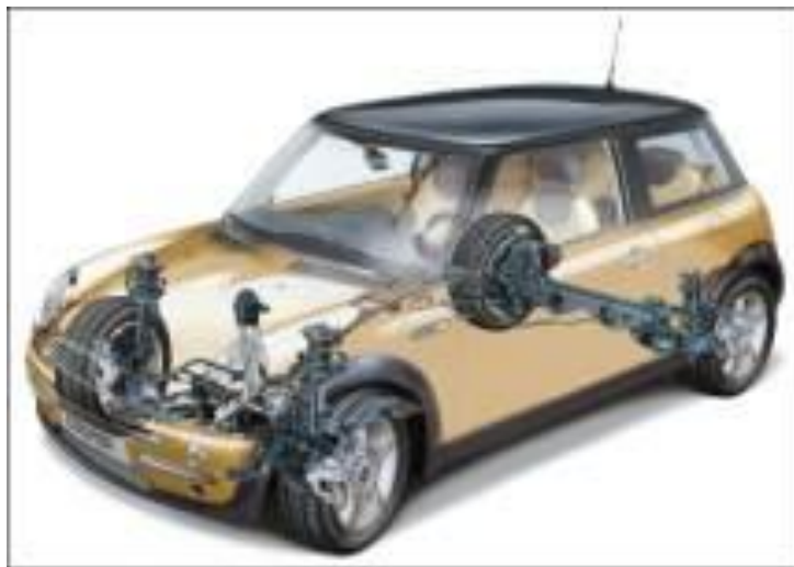
Слика 3.11. : Систем еластичног ослањања и систем за управљање возила BMW Mini[18]
