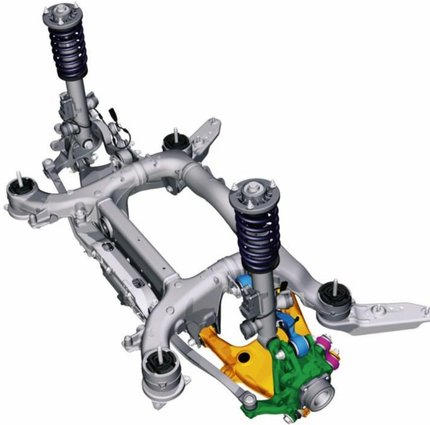
Слика 3.12. : Предњи систем еластичног ослањања и систем за управљање возила BMW 7 [12]
