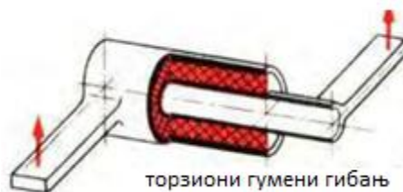
Слика 2.18. : Торзиона опруга са гуменим елементом [9]
