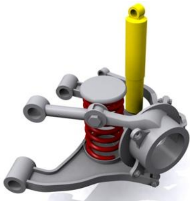
Слика 2.11. : Систем са померањем точка у две равни [5]
