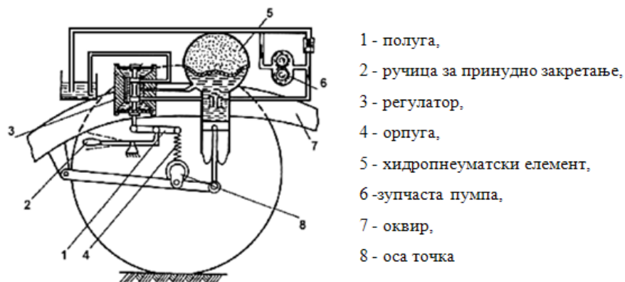
Слика 2.27. : Регулатор хидропнеуматског система еластичног ослањања [6]
