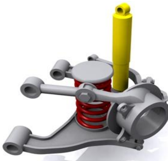
Слика 3.9. : Варијанте предњег система еластичног ослањања са две попречне вођице [8] Слика 3.10. : multilink ослањање [8]
