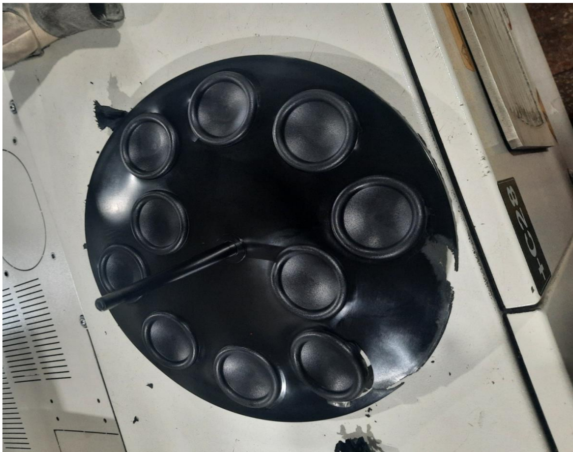
Слика 24 - Пример изливених чепова са вишком материјала око себе (паштетом)
