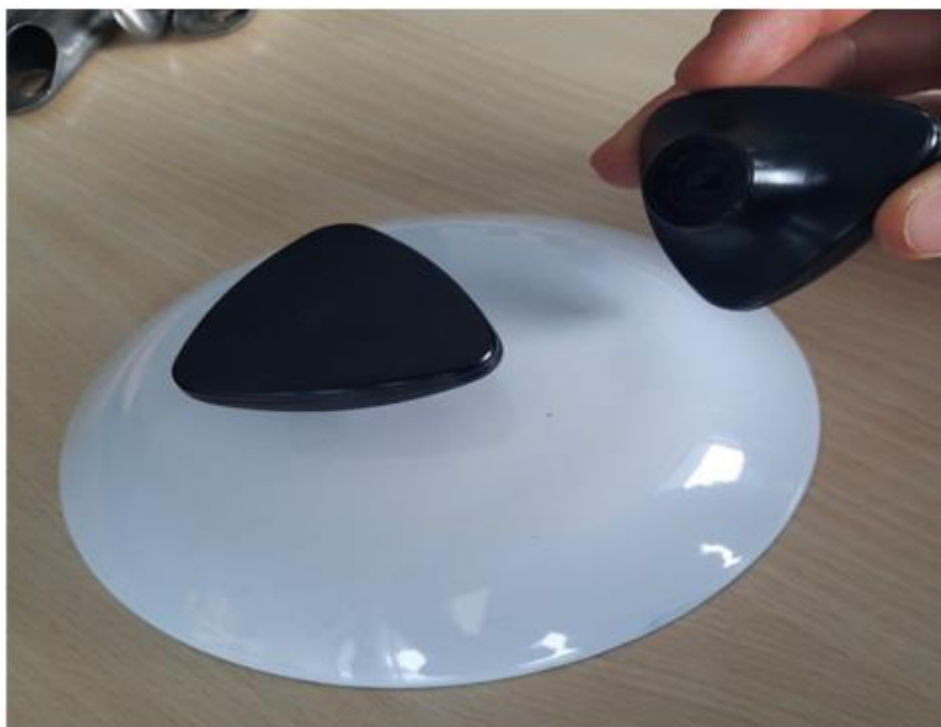
Слика 17 - Прототип бакелитне ручице израђене на 3D штампачу
