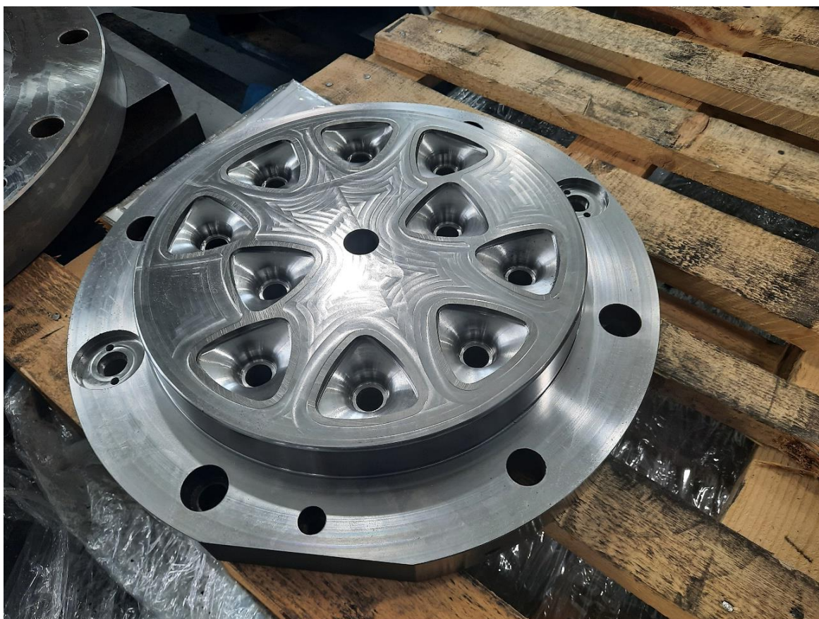
Слика 21 - Кокила са технолошком површином за позиционирање алата
