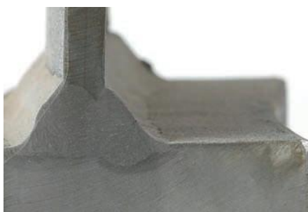
Слика 15. Заобљење у корену код Т-споја добијеног FSW поступком [1]
