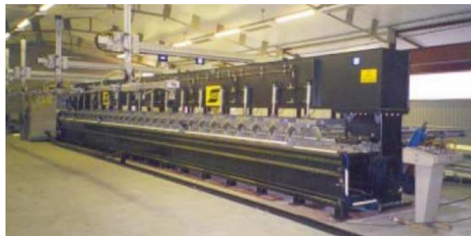
Слика 37. Машина за заваривање поступком FSW, за дуге шавове произведена у „ESAB“-у [6]
