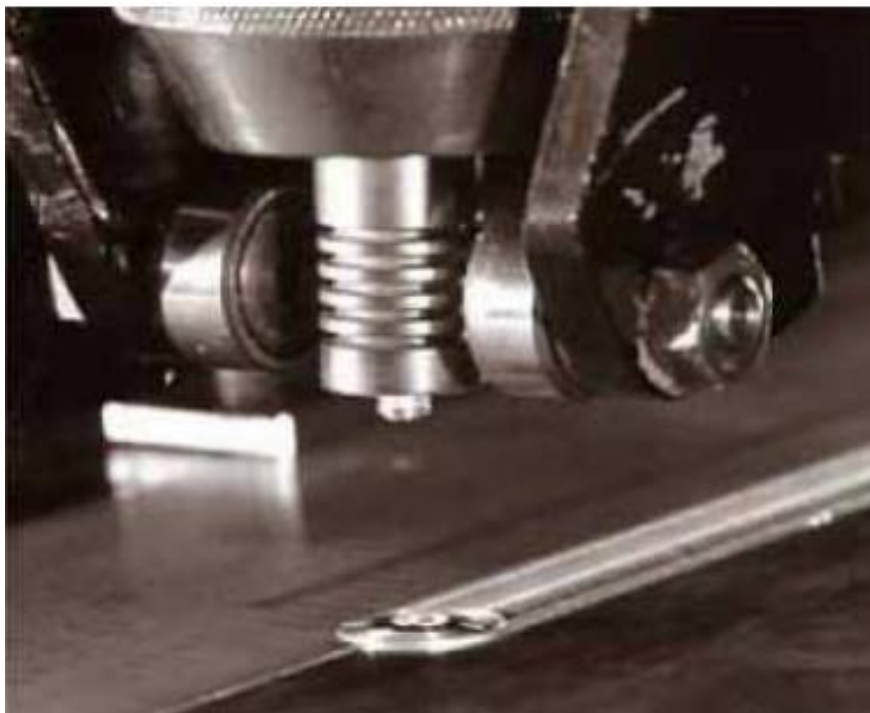
Слика 36. Систем за контролу дубине продирања чела алата у материјал који се састоји од два помоћна ваљка [6]
