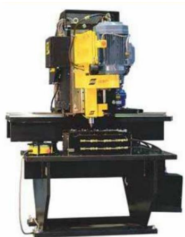
Слика 38. Мања машина за заваривање поступком FSW произведена у „ESAB“-у [6]
