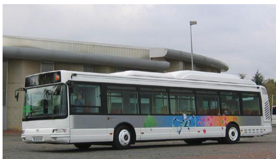
Слика 19. Iris bus Agora gaz, батерија на задњем делу крова [24]
