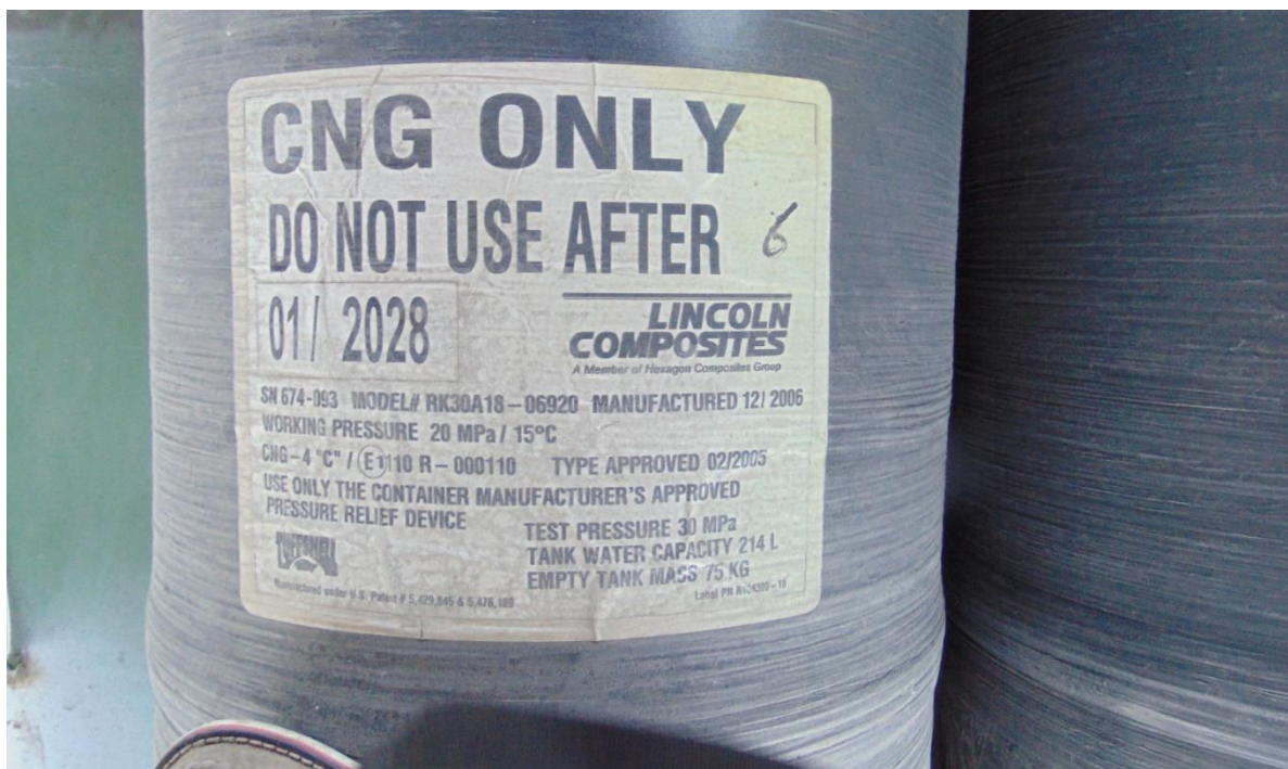
Слика 28. Хомологацијска ознака ретервоара КПГ-а
