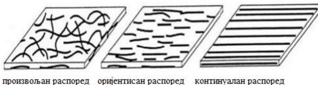
Слика 2.3 Распоред структурних елемената у композиту [1]
