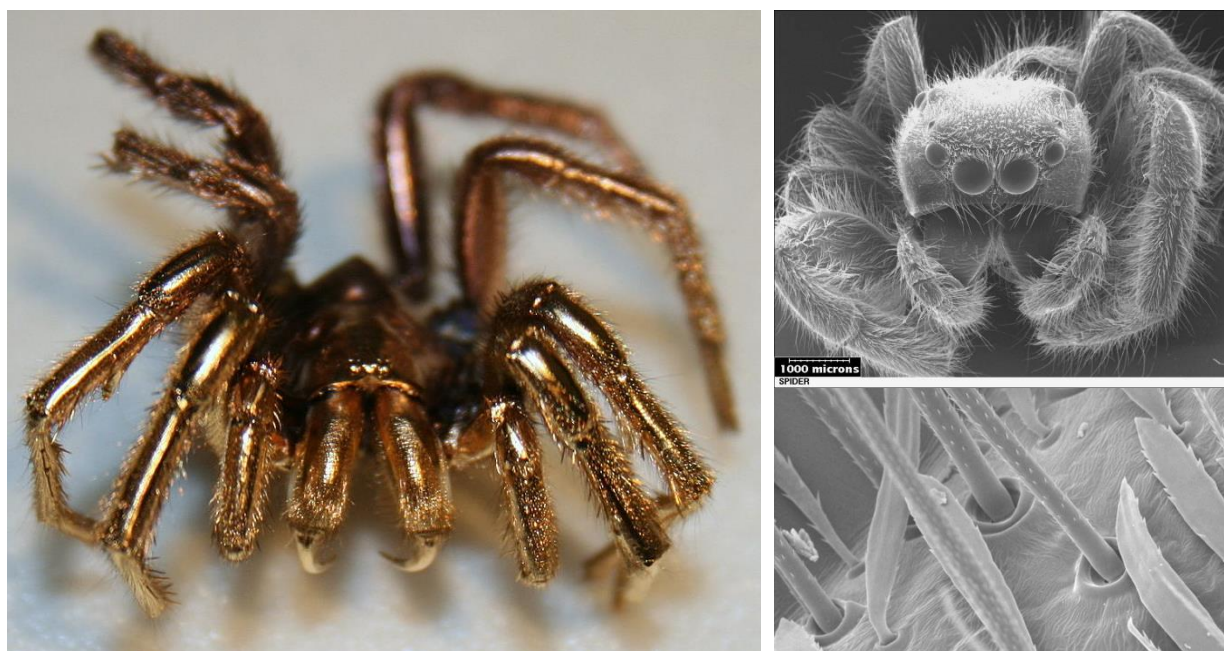
Слика 6.6 – Паук превучен превлаком злата, припремљен за SEM анализу [4].
