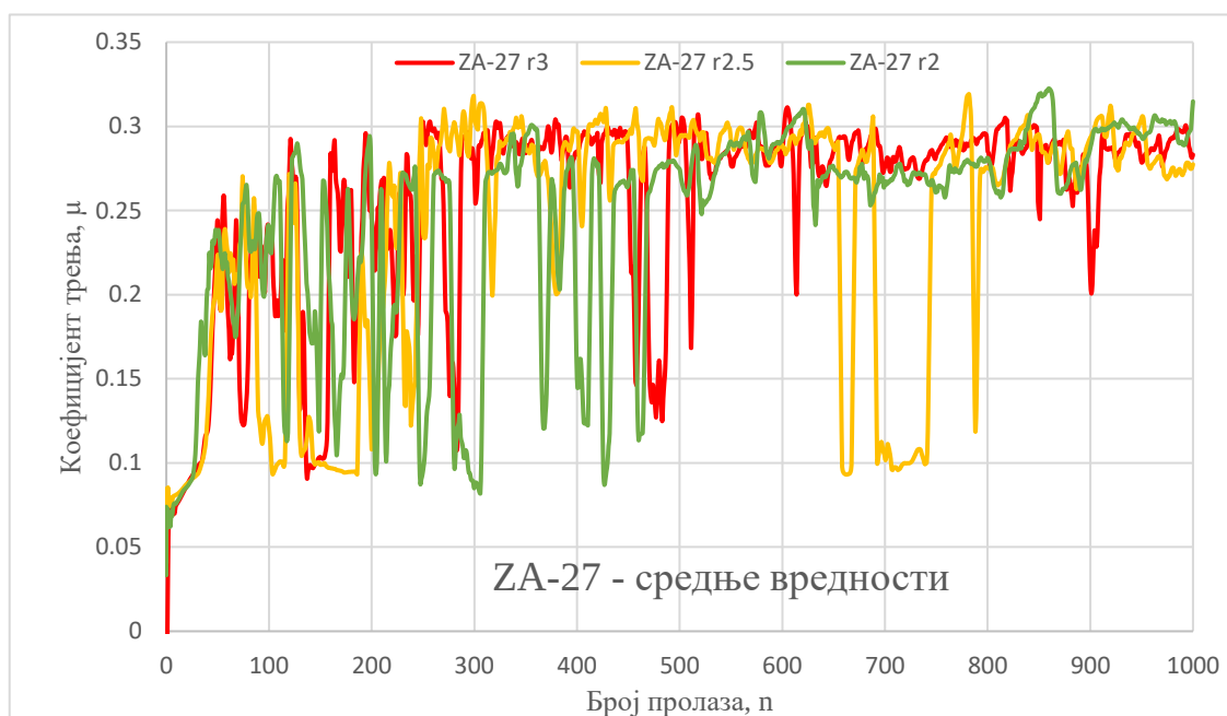
Слика 7.13 Дијаграм средње вредности коефицијента трења у зависности од броја пролаза за ZA-27 металну основу, r=3\text{mm} , r=2,5\text{mm} и r=2\text{mm}
