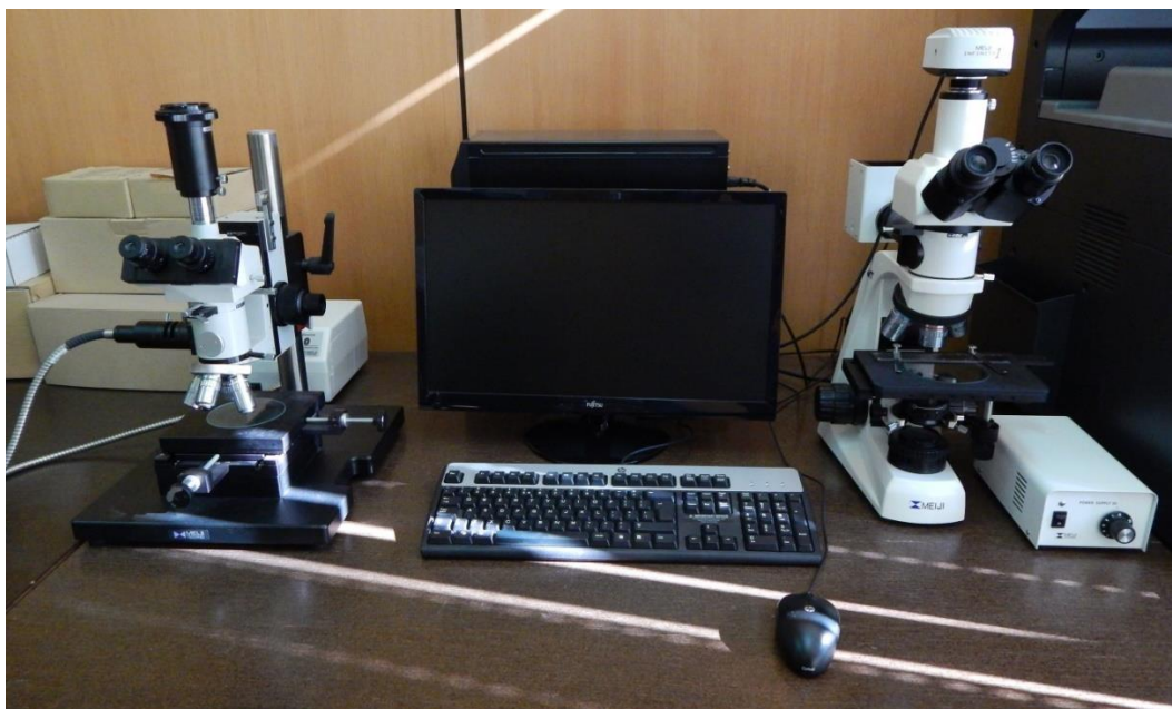
Слика 6.5 „MEIJ Techno“ оптички микроскопи: алатни (лево) и металуршки (десно) [4].
