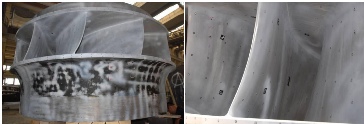
Слика 6.1 - Радно коло ХЕ Пива припремљено за фотограметријско мерење и 3D дигитализацију
