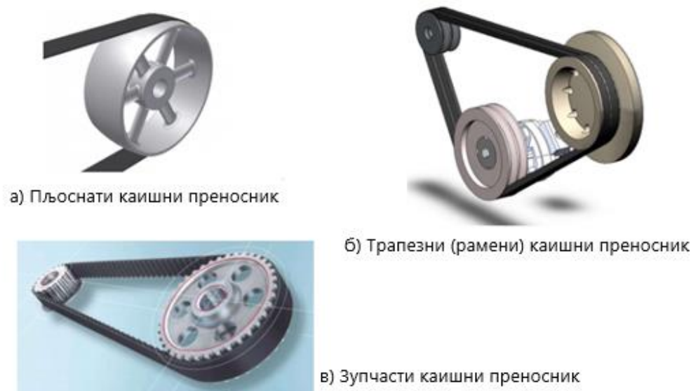
Слика 10. Облици профила каиша, [1]
