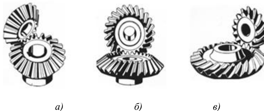
Слика 6. Конични зупчasti парови са: правим (а), косим (б) и завојним зупцима (в), [3]
