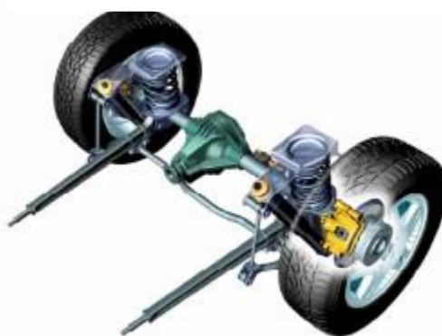
Слика 27. Задњи крути погонски мост (Mercedes G klasa)[3]
