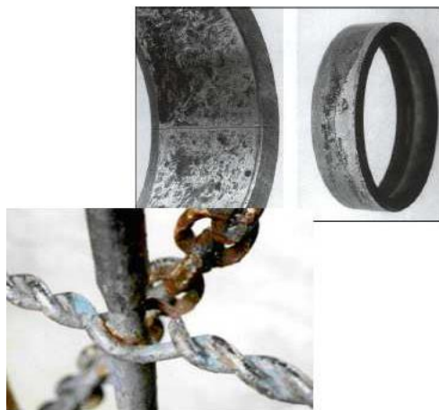
Слика 2.7. Корозија настала при трењу
