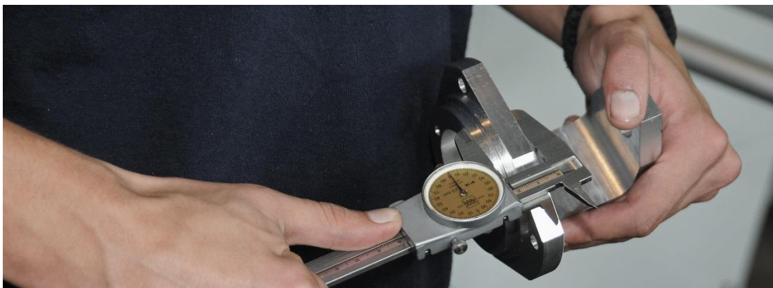
Слика 23 Приказ контроле тачности уз помоћ мерног инструмента [5]
