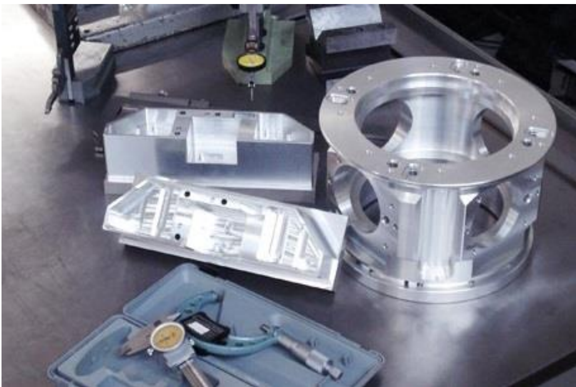
Слика 31 Контролна сала са мерним алатима и деловима за контролу [4]
