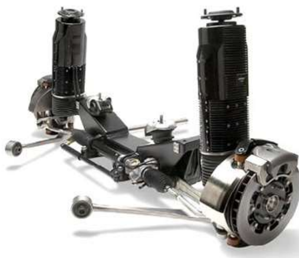
Слика 47 - Босе ослањање на предњој осовини [16]
