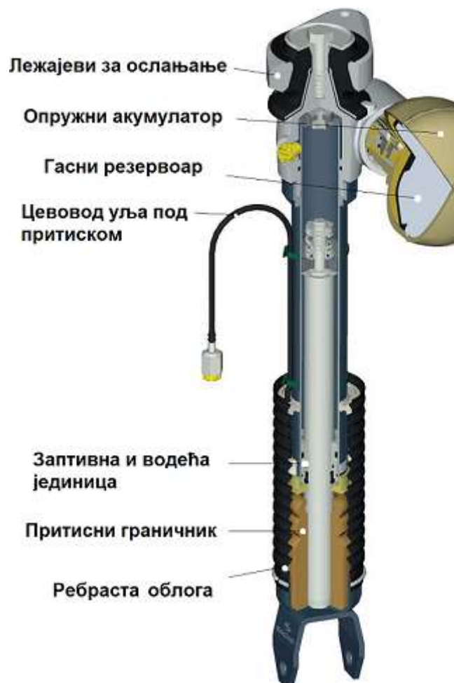
Слика 38 - Опружни цилиндар [7]
