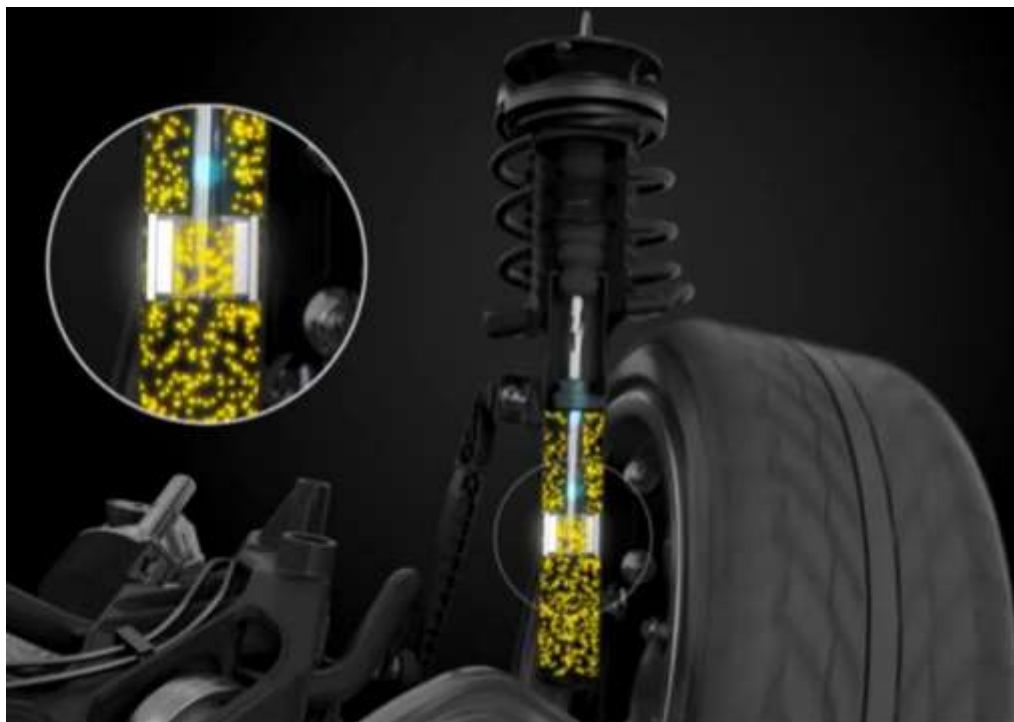
Слика 50 - Амортизер испуњен хидрауличном течношћу [18]
