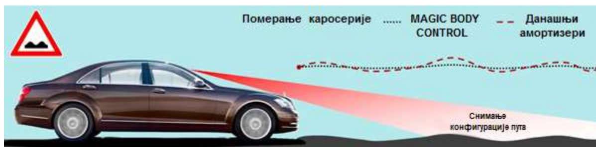
Слика 54 - Снимање конфигурације пута испред возила [19]
