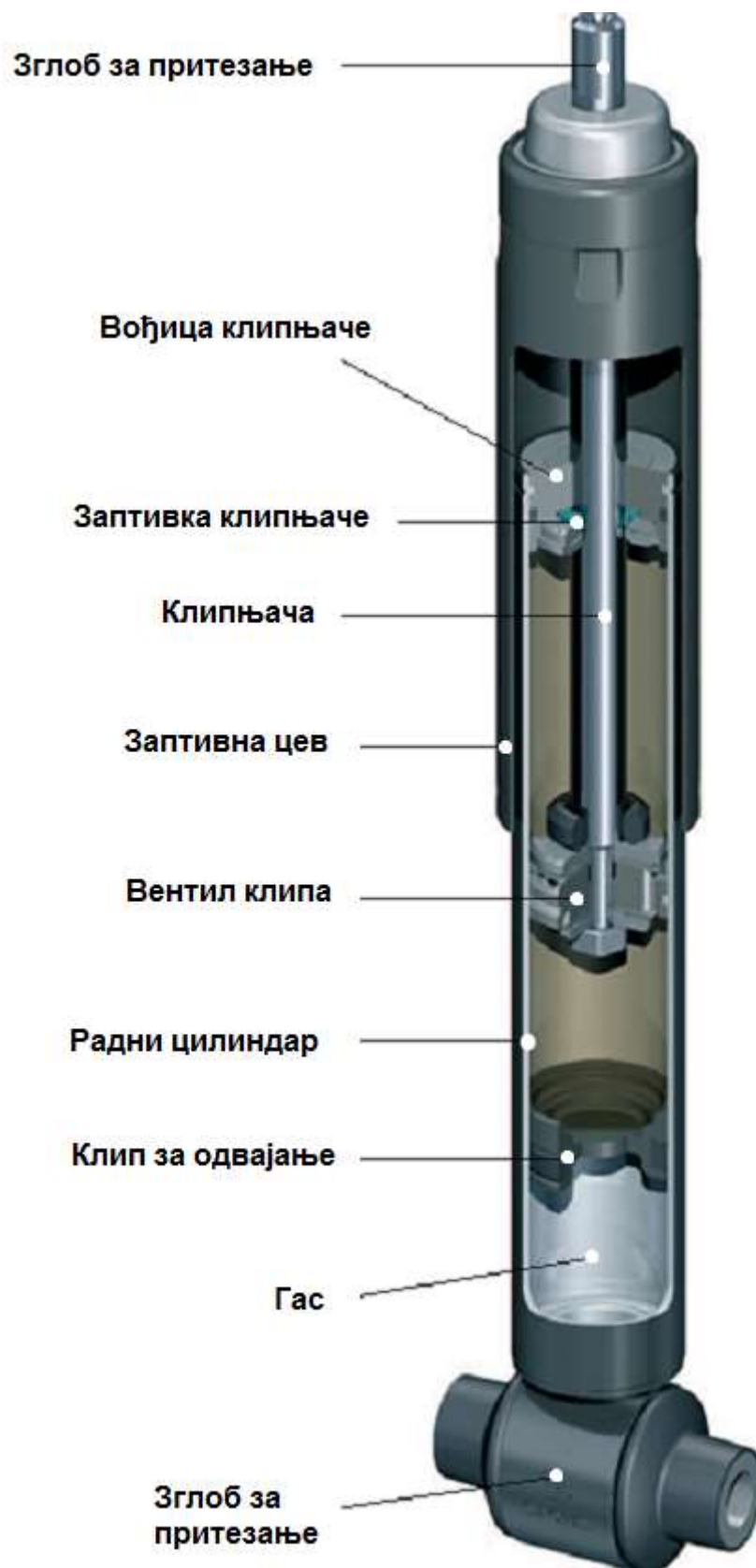
Слика 14 - Телескопски једноцевни хидраулични амортизер [7]
