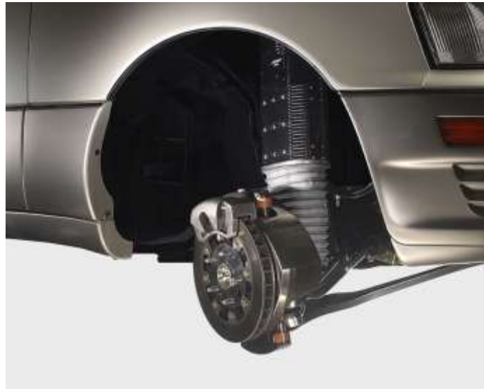
Слика 48 - Bose ослањање на Lexus LS400 [16]
