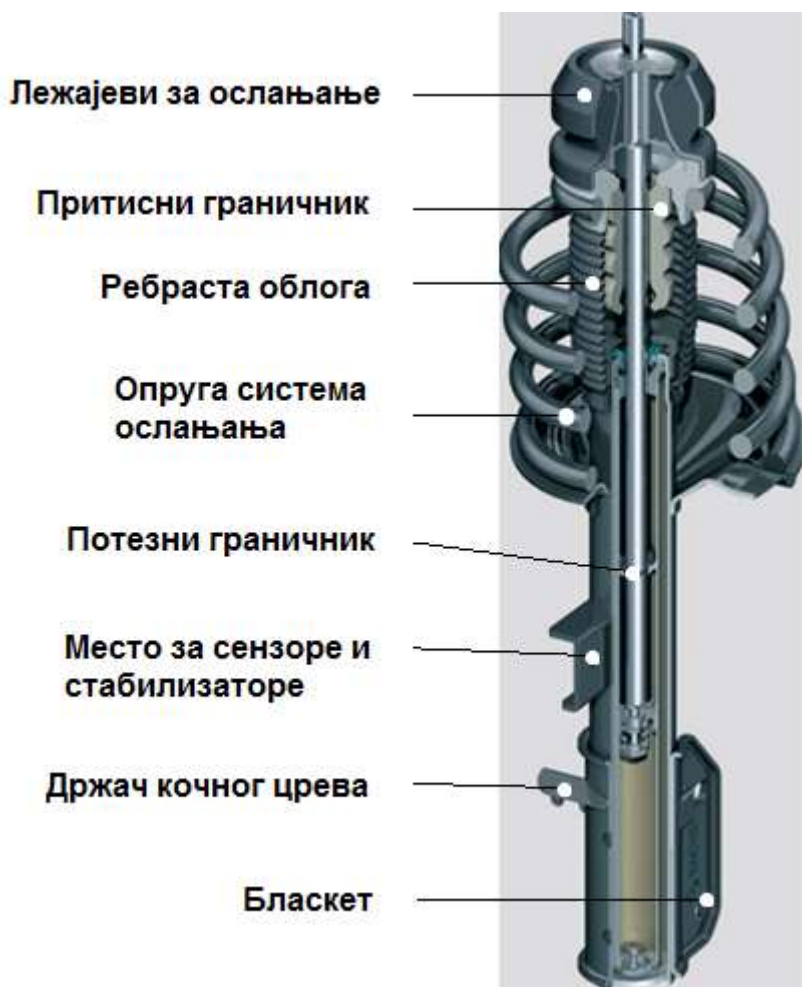
Слика 37 - Модул опружне ноге [7]
