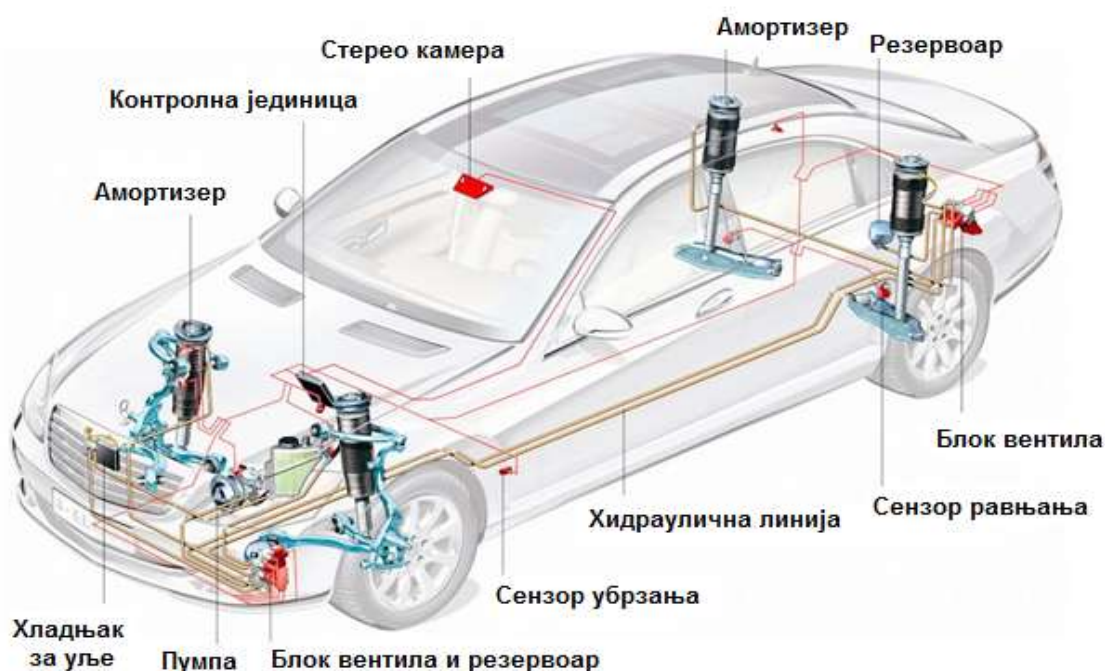
Слика 53 - MAGIC BODY CONTROL систем ослањања [19]
