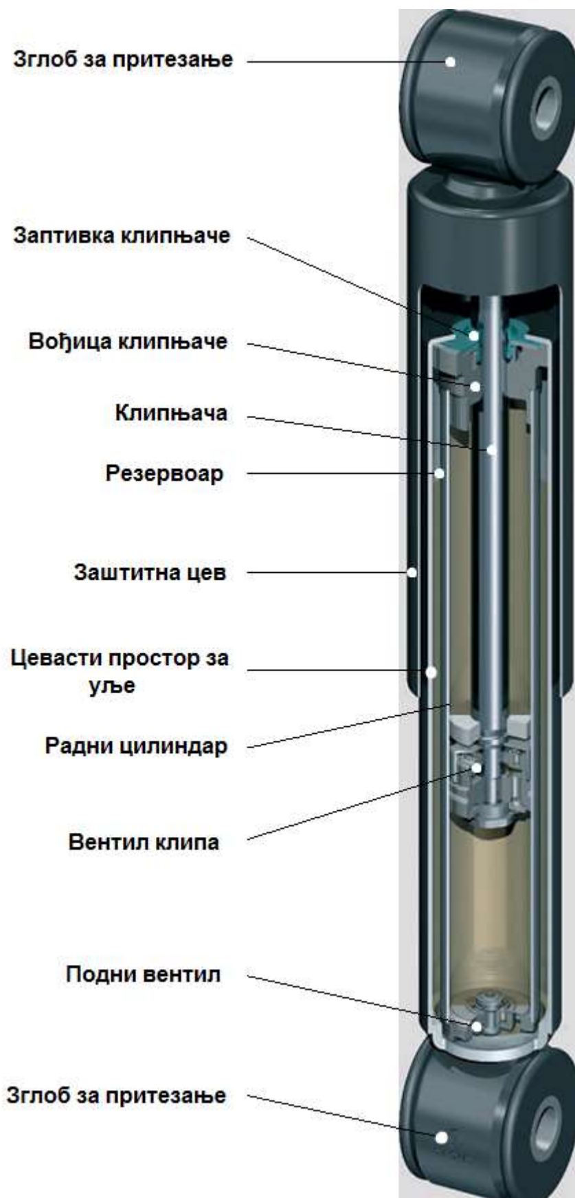
Слика 16 - Двоцевни хидраулични телескопски амортизери [7]
