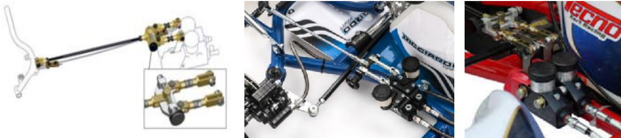
Слика 64. Система активирања предње и задње кочнице са освртом на кочионе цилиндри предње и задње кочнице [35, 36, 42]
