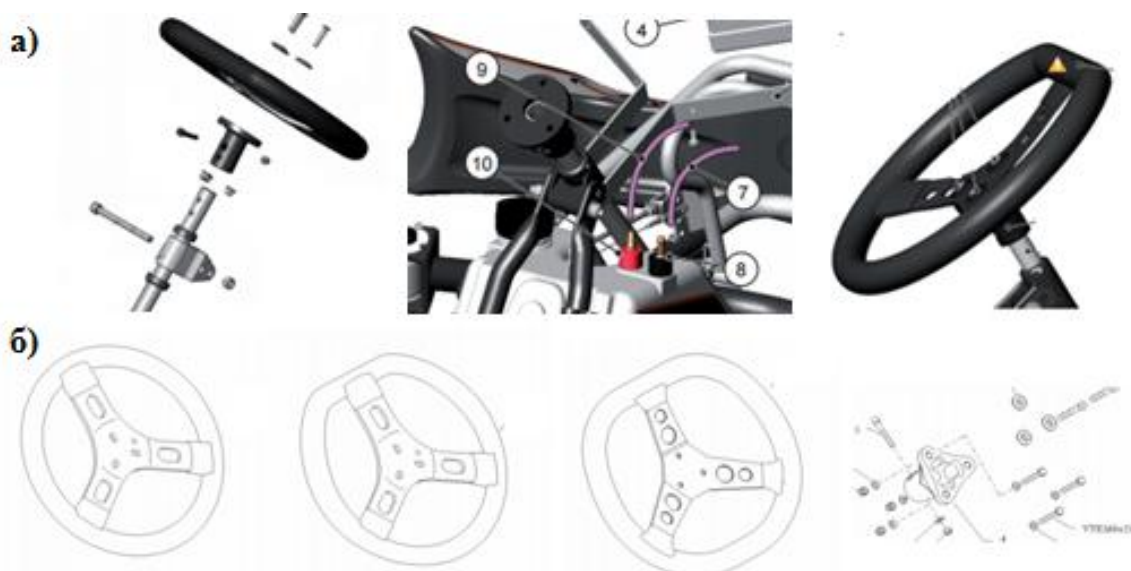
Слика 43. Извођење система точка управљача, где је а) начини постављања точка управљача, б) варијанте управљачких точкова [32,33]
