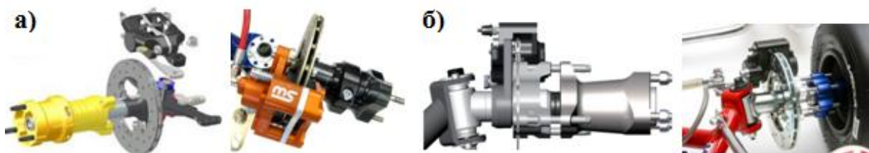
Слика 65. Извођење система кочница на предњим точковима, где су: а) тип извођења без осовиница, б) тип извођења са осовиницама споја два дела главчине [26, 33, 35, 45]
