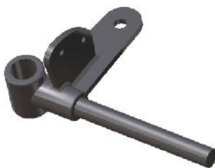
Слика 76. Усвојени елемент везе између точкова, рама возила и система за управљање
