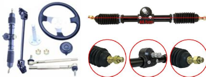
Слика 50. Елемената другог начина извођења система управљања [39]
