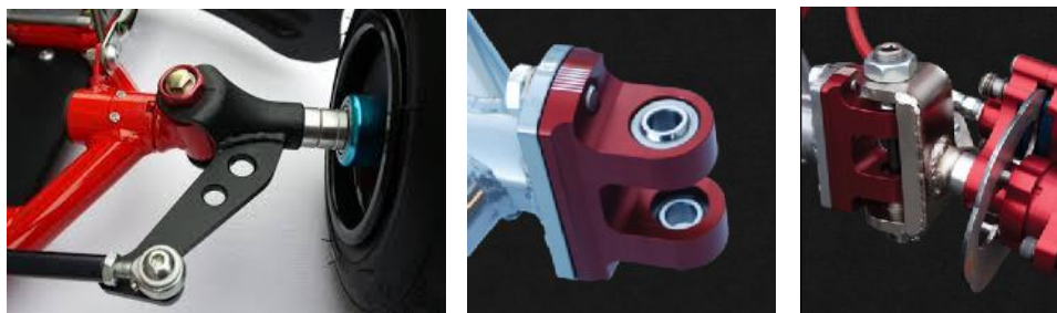
Слика 49. Други начин извођења споја система управљања са рамом [38]
