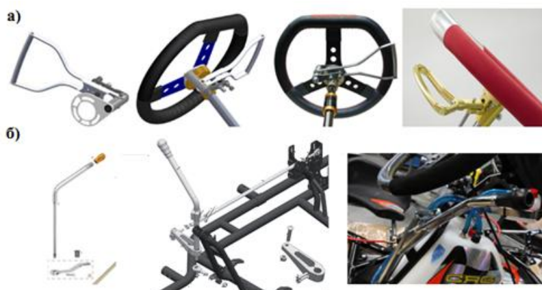
Слика 59. Елементи система промене степена преноса, где су а) Приказ елемената искључивања спојнице, б) приказ ручице и система промене степена преноса [31, 33, 36, 44]
