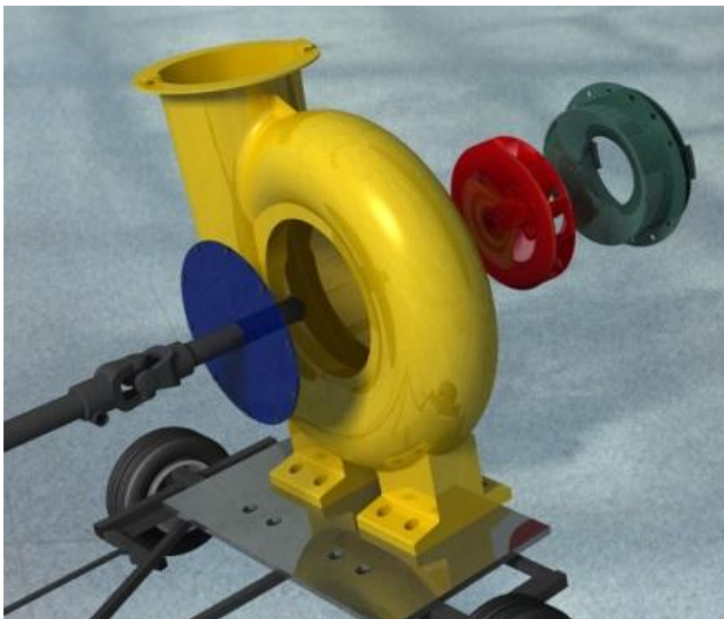
Сл. 16 – Шема склапања турбопумпе обрађене у овом завршном раду
