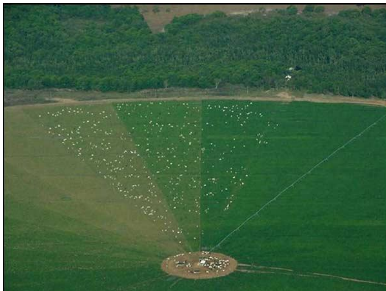
Сл. 6 – Заливање парцеле центар пивот системом
