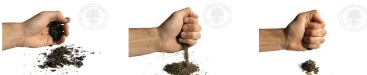
Сл.1 – Различите влажности земљишта, а) сува земља, б) влажна земља, ц) мокра земља
