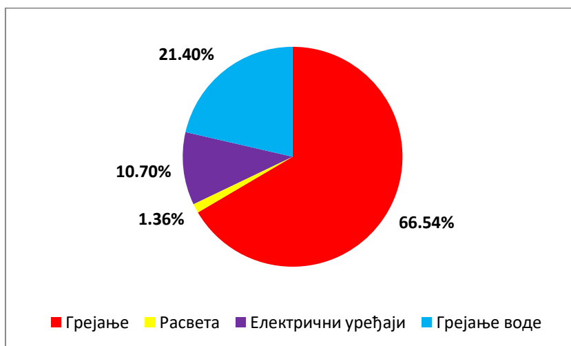
Слика 32. Расподела потрошње електричне енергије у оптималном случају
