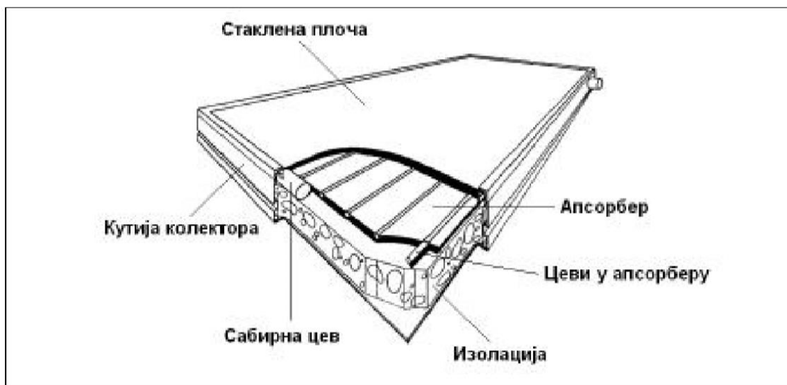
Слика 9. Равни водени застакљени соларни колектор, [12]
