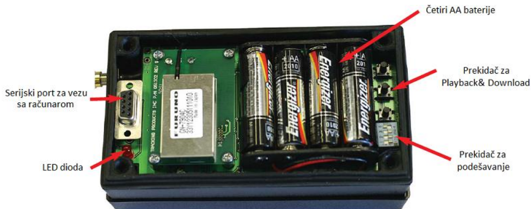
Slika 33 - Prikaz glavnog prekidača i postavljanja baterija
