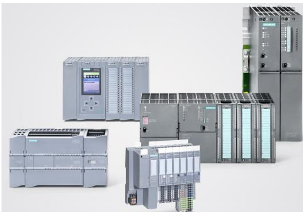
Слика 6. Изглед модуларног ПЛЦ контролера [5]
