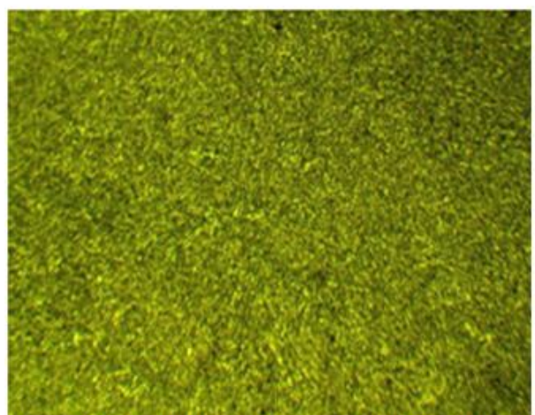
МШ – међуфазна структура, линија II – II
