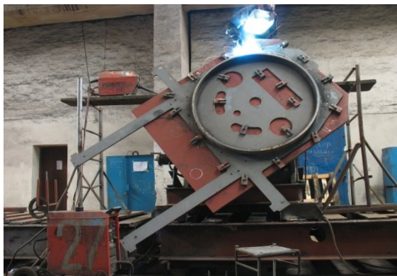
Слика 4.3. Заваривање у алату
