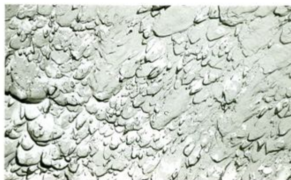
Слика 4.22. Крти и жилав лом увећани под електронским микроскопом 10000х
