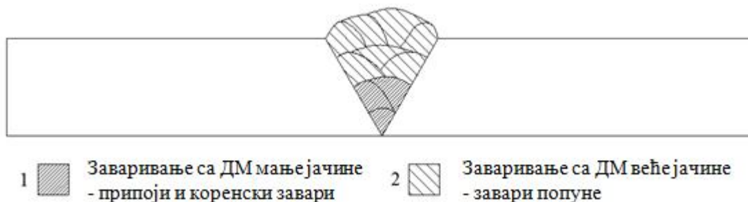
Слика 3.5. Вишеслојно заваривање различитим додатним материјалима
