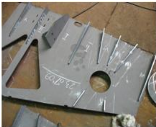
Слика 4.2. Обележавање редоследа заваривања
