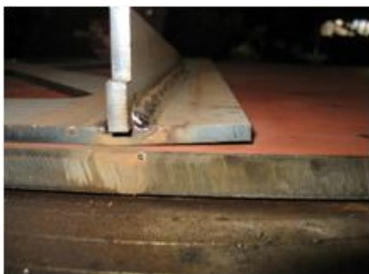
Слика 4.6. Деформације основног материјала после заваривања
