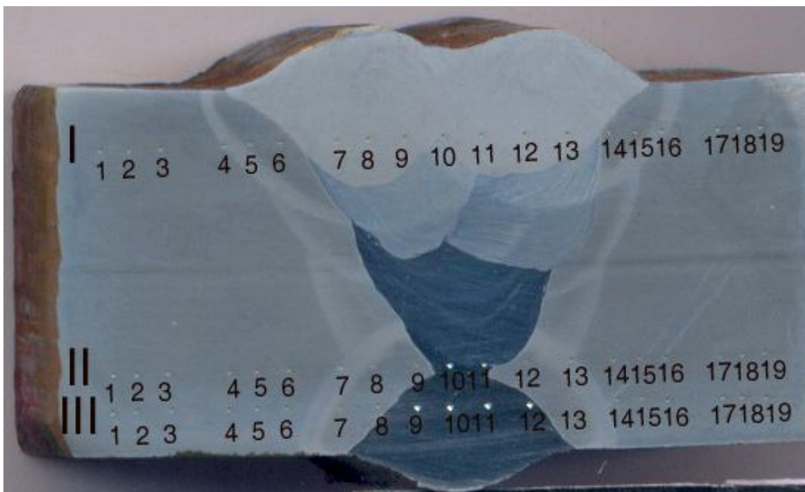
Слика 4.36. Металографски узорак: плоча - I узорак - 1 за испитивање макроструктуре и мерење тврдоће
