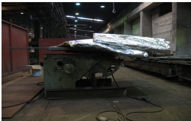
Слика 4.5. Успорено хлађење после заваривања
