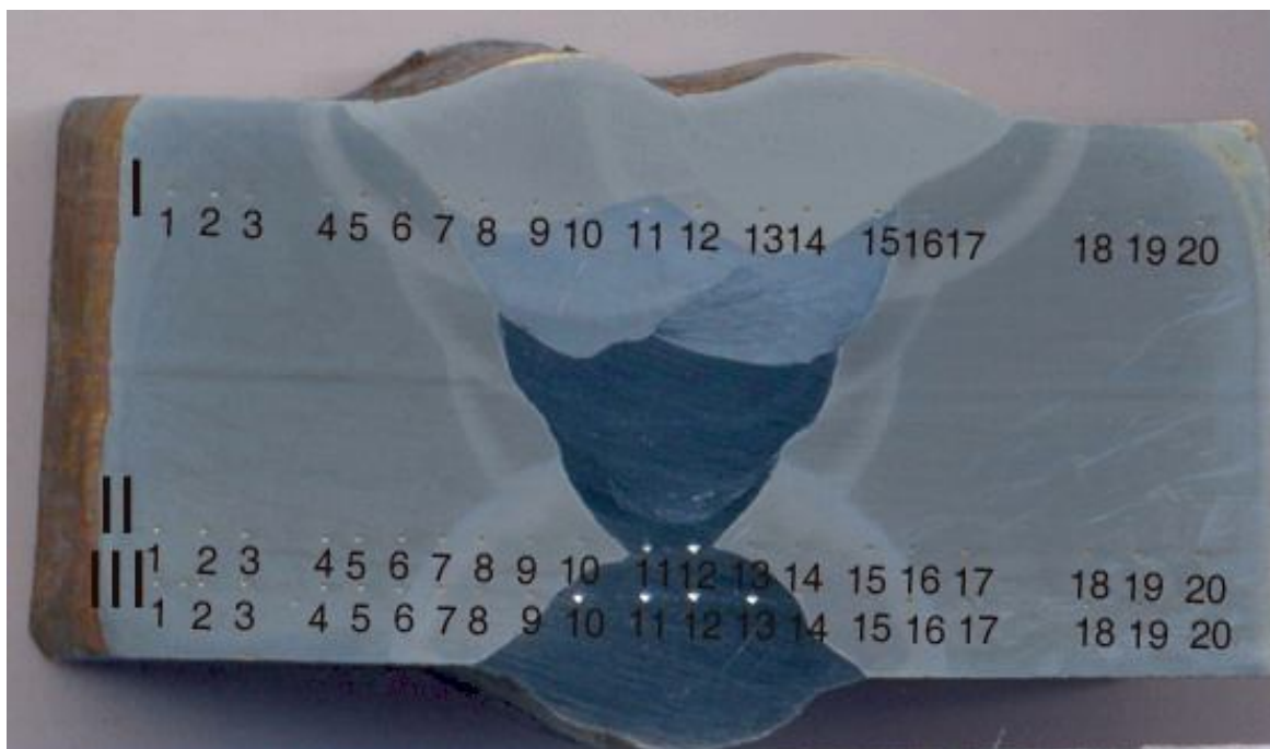
Слика 4.39. Металографски узорак: плоча - I узорак - 2 за испитивање макроструктуре и мерење тврдоће
