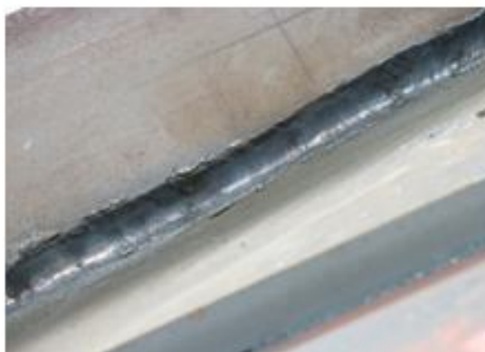
Слика 4.4. Жлебљење коренског пролаза графитном електродом
