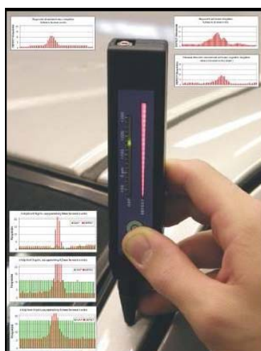
Сл. 4.14. MICROSCAN-Уређај за проверу заварених спојева и фарбе
