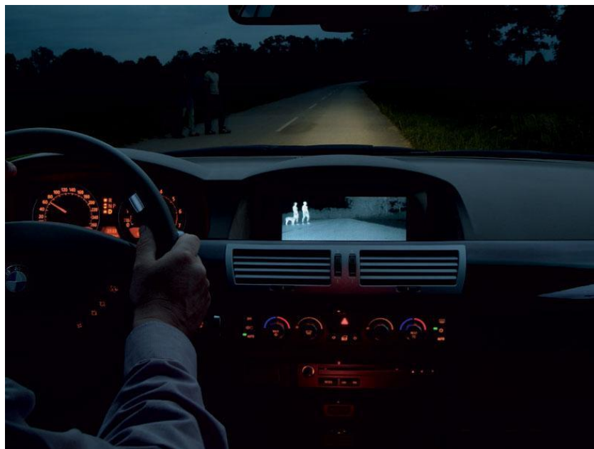
Слика 30. BMW Night Vision систем са термалном камером, [24]
