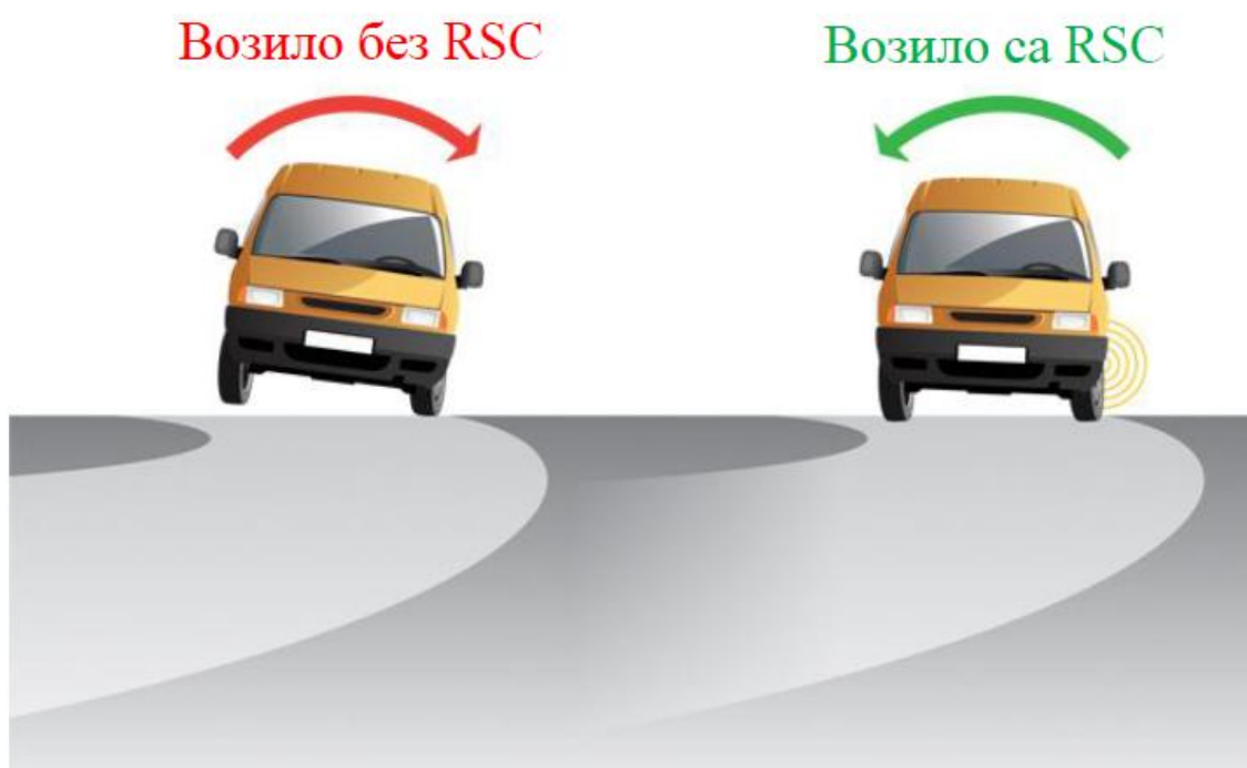
Слика 24. Упоредни приказ понашања возила са и без RSC-а, [18]
