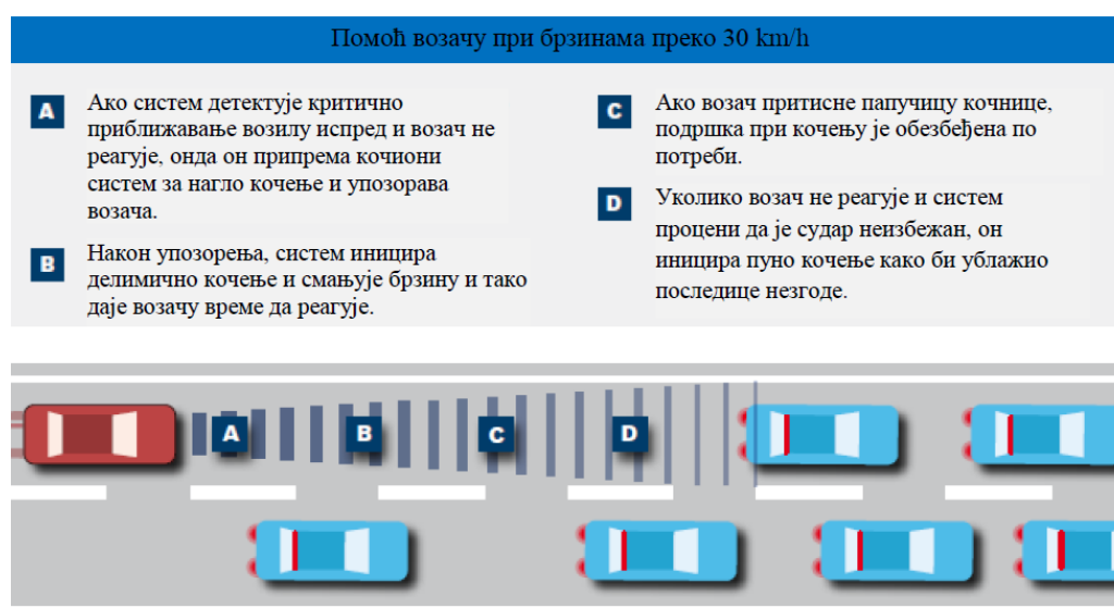
Слика 13. Начин функционисања система при брзинама преко 30 km/h, [16]
