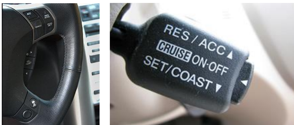
Слика 8. Дугмад и ручица на волану за подешавање АСС, [4]
