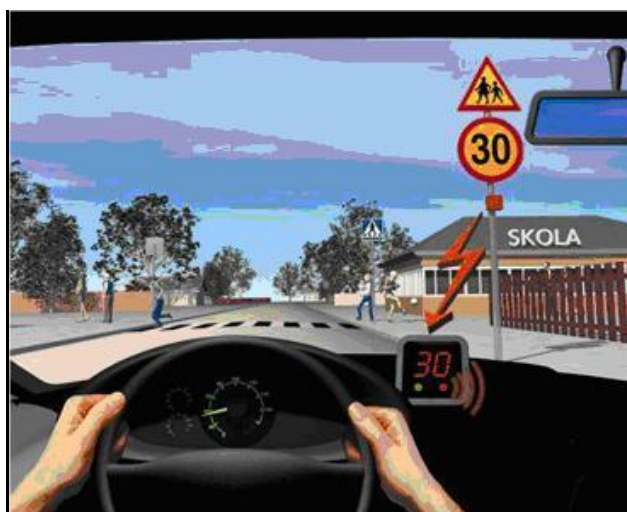
Слика 25. ISA даје звучно упозорење возачу да смањи брзину, [4]
