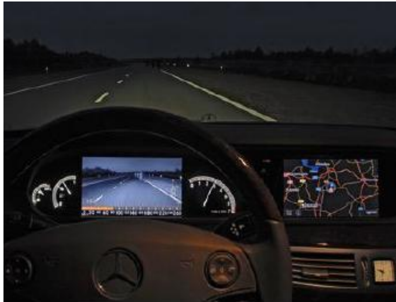
Слика 29. Mercedes Night Vision систем са инфрацрвеном камером, [23]
