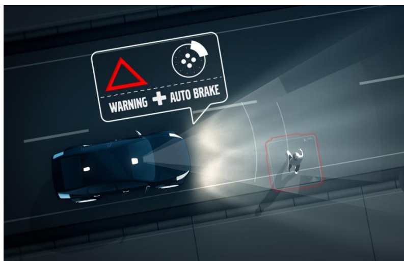
Слика 28. Volvo Pedestrian Safety System даје упозорење возачу о предстојећем удару, [21]
