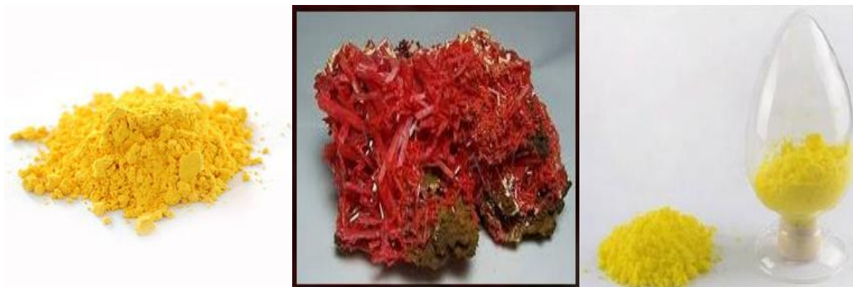
Слика 3. Неки од инхибиторских пигмената: цинк-хромат; црвено олово; стронцијум-хромат [3]
