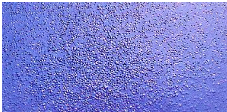
Слика 16. Претерано наношење прскањем [16]
