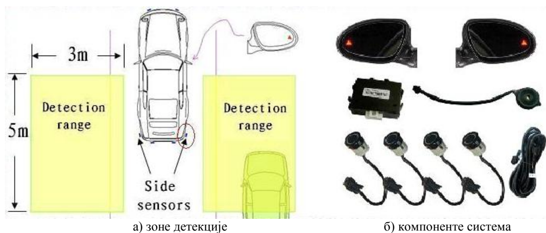
Слика 35 – Зоне детекције и компоненте система Blind Spot Assist, [32]
