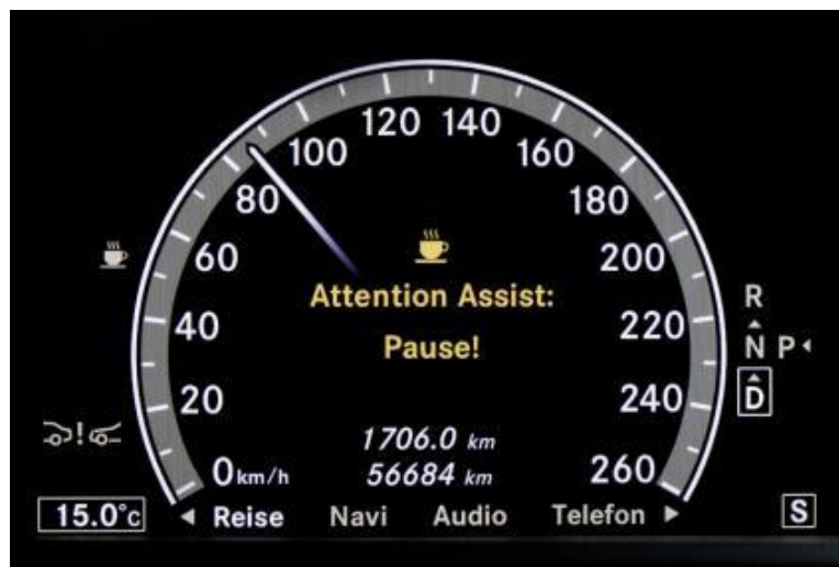
Слика 31 - Упозорење система Attention Assist [28]
