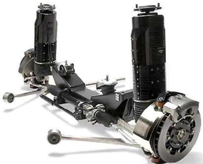
Слика 25 – Пример модерног решења активног вешања „Bosch“, [22]
