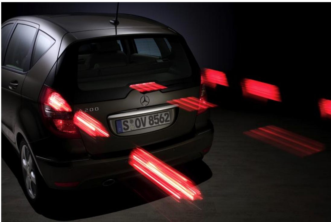
Слика 27 - Рад адаптивних светла кочница [23]
