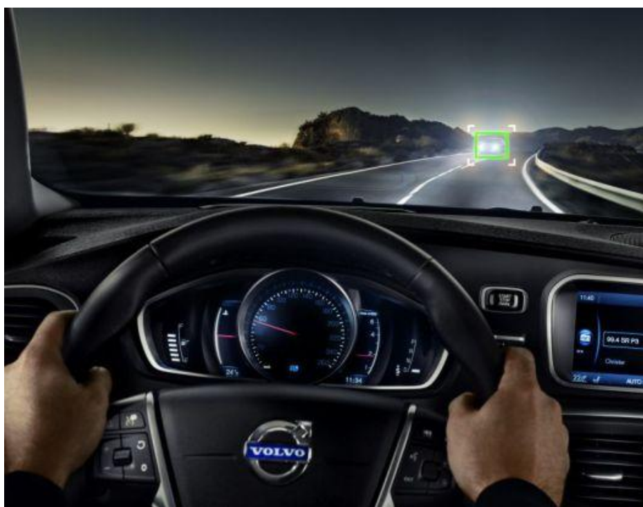
Слика 33 – Функционисање система за надгледање коловозне траке, [30]
