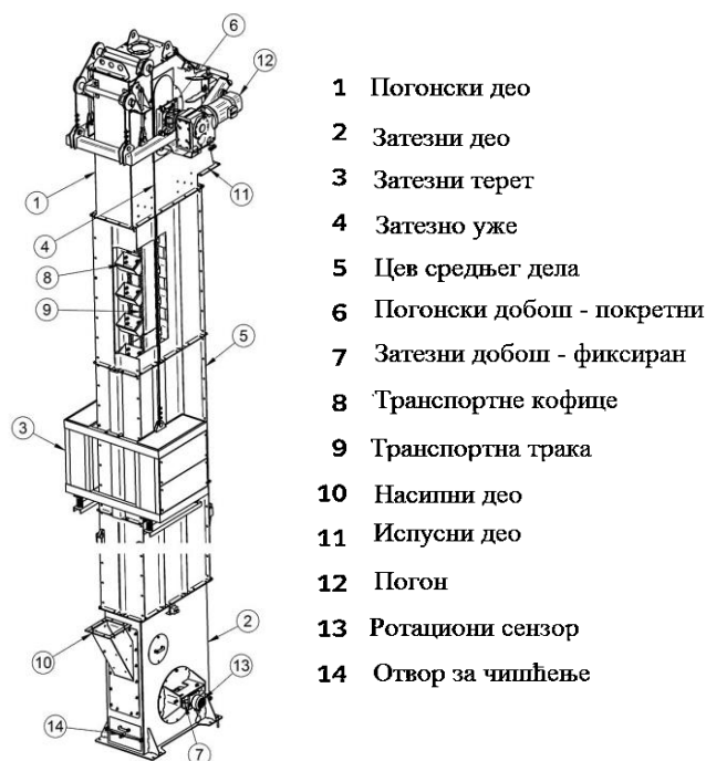
Слика 2.3 Изглед кофичастог елеватора са деловима [4]
