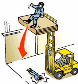
Слика 36: Повреда при коришћењу привремено конструисаних платформи [6]
