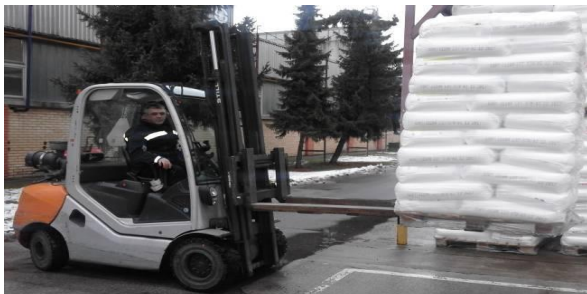
Слика 49: Виљушкар STILL тип RX 70-35T
