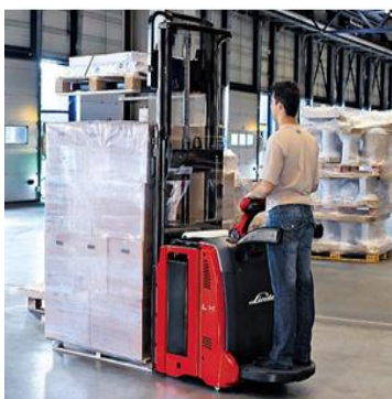
Слика 7: Виљушкаре код којих руковаоц стоји
