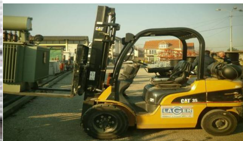
Слика 50: Виљушкар CATERPILLAR тип GP 35N
