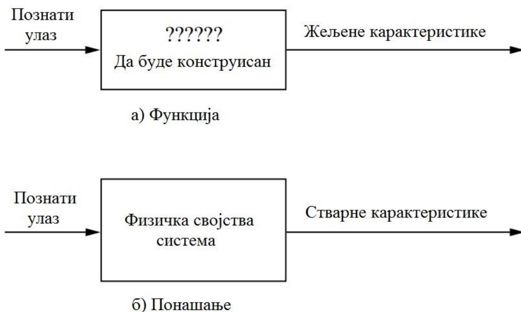
Слика 4. Функција и понашање [2]
