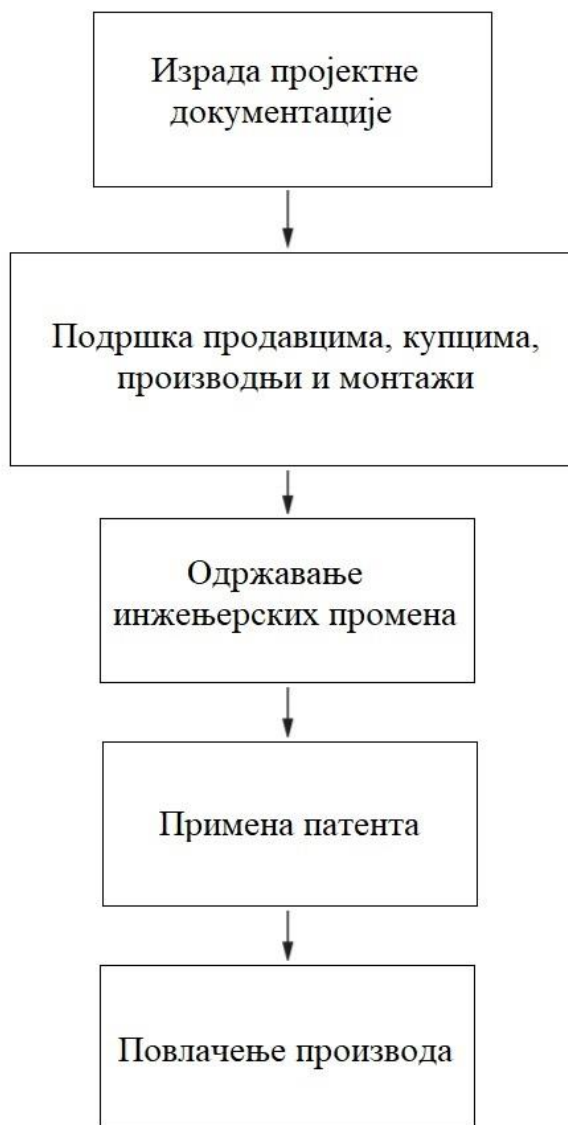
Слика 14. Активности подршке производа [2]
