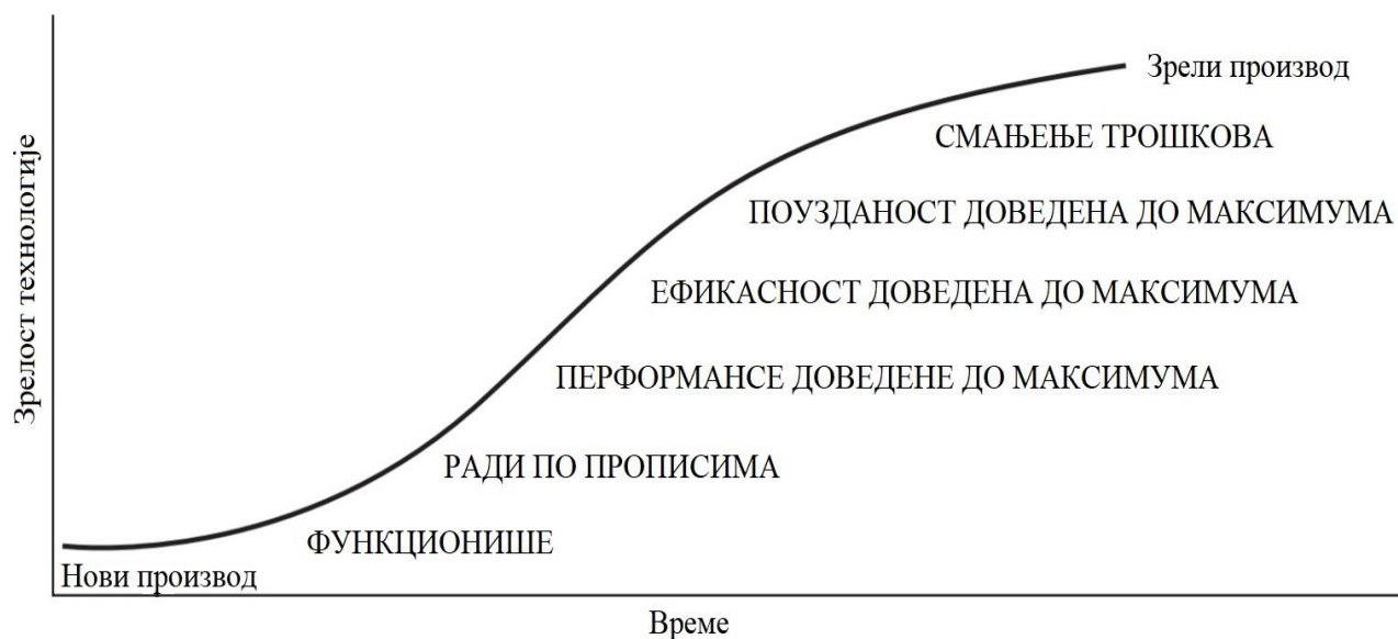
Слика 16. Крива зрелости производа „S“ [2]
