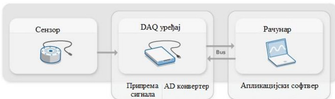
Слика 17. Типични систем за аквизицију података
