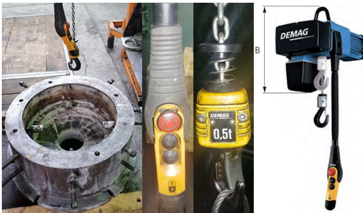
Слика 5.12 Алат за извлачење (стега), уз приказ дизалице за подизање
