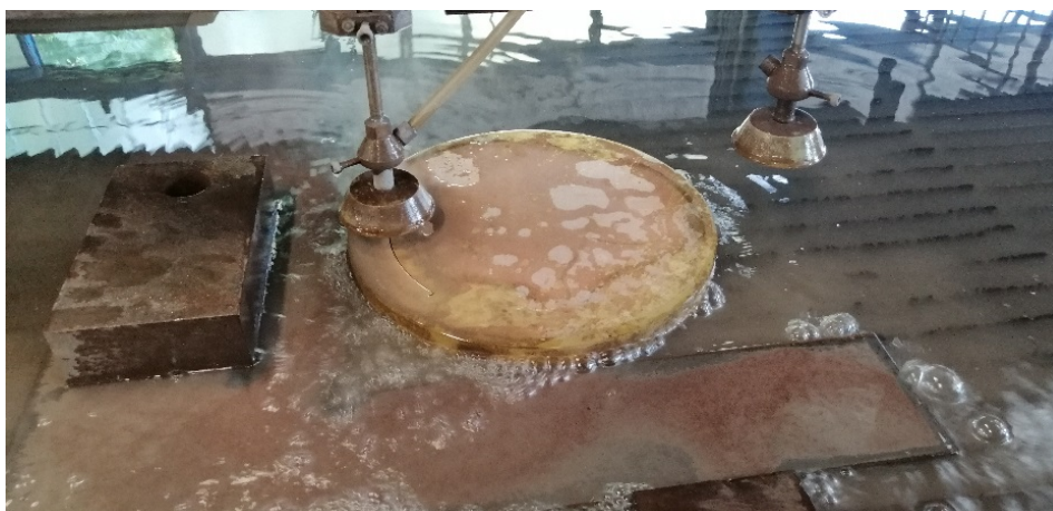
Слика 5.18 Исецање припремка Water-Jet поступком
