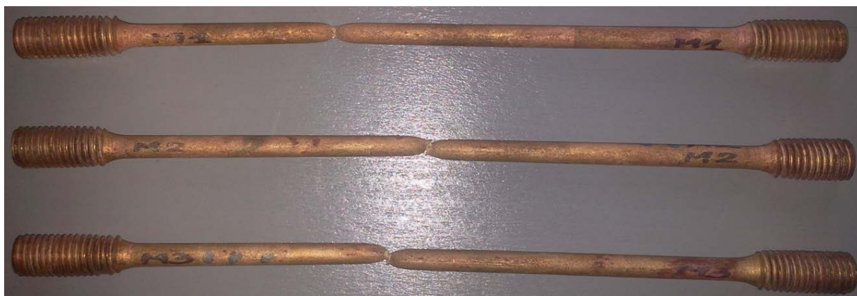
Слика 5.5 Епрувете након процеса једноосног затезања
