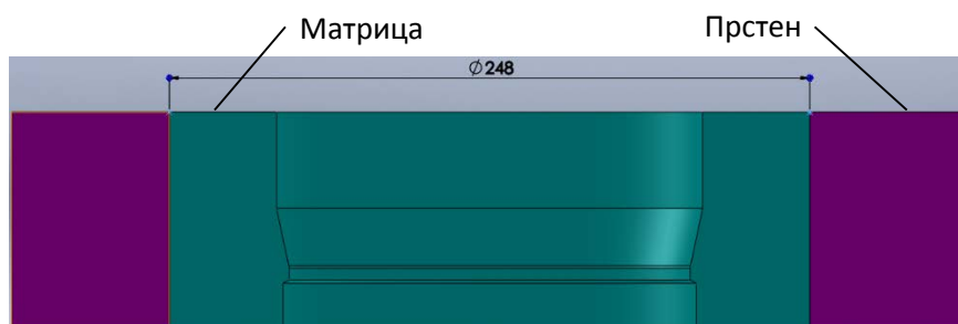
Слика 6.5 CAD модел склопа доње матрице са ојачавајућим прстеном
