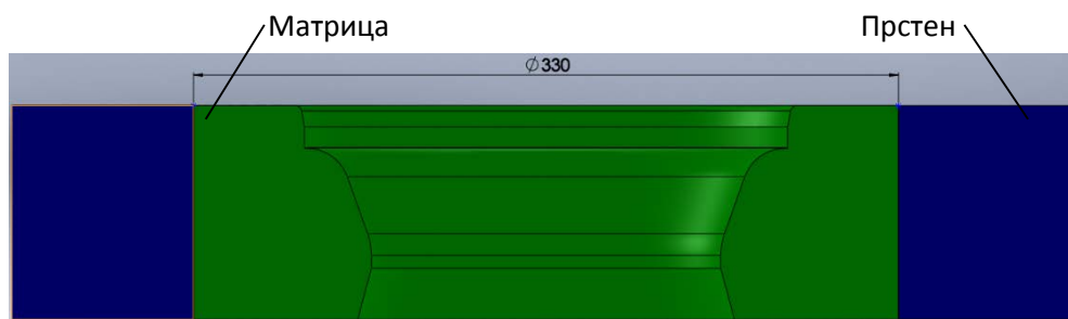
Слика 6.2 CAD модел склопа горње матрице са ојачавајућим прстеном
