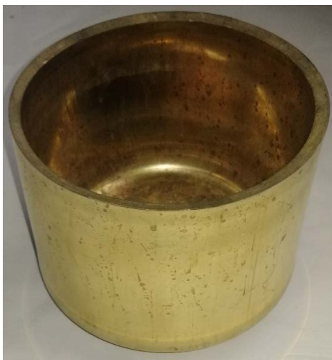
Слика 6.1 Обрадак након операције дубоког извлачења
