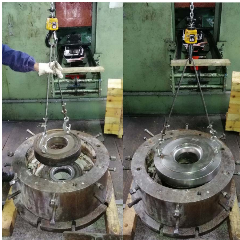
Слика 5.13 Монтажа доње и горње матрице за извлачење
