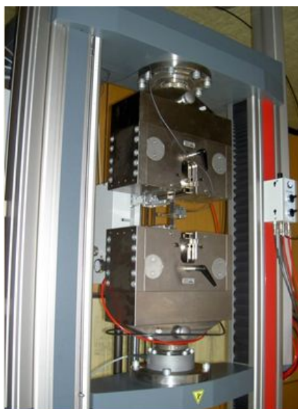
Слика 5.1 Zwick/Roell Z100 машина за испитивање материјала тестом једноосног затезања [14]
