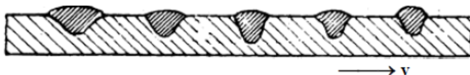
Слика 43. Утицај брзине заваривања на облик шави [15]
