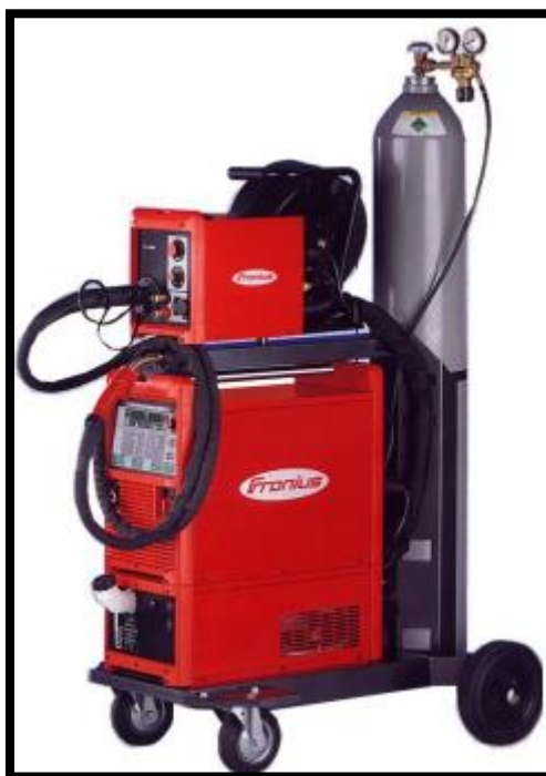
Слика 24. Реалан изглед MIG/MAG уређаја за заваривање са боцом заштитног гаса
