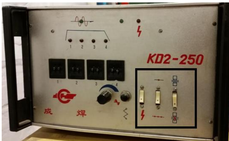
Слика 13. Контролни ормар типа KD2 – 250 [6]
