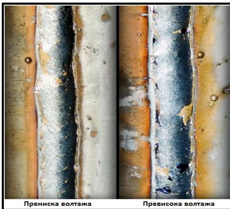
Слика 40. Приказ лоших завара зависно од напона [15]
