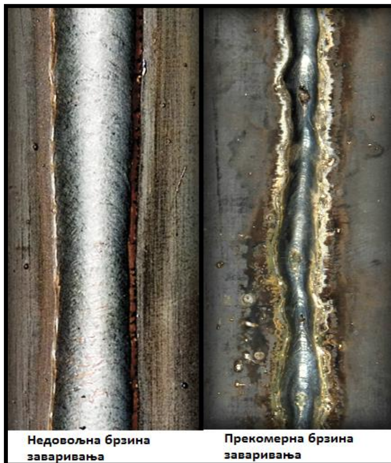
Слика 44. Приказ лоших заваара зависно од брзине заваривања
