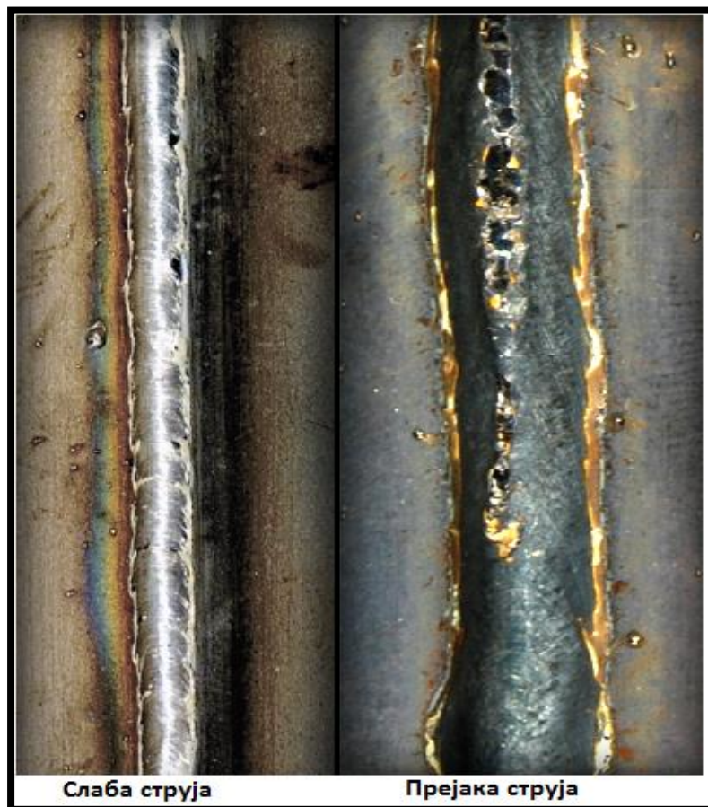
Слика 37. Приказ лоших завара зависно од струје [15]
