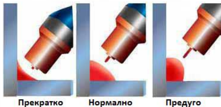
Слика 38. Шематски облици вара с обзиром на дужину излаза жице [15]
