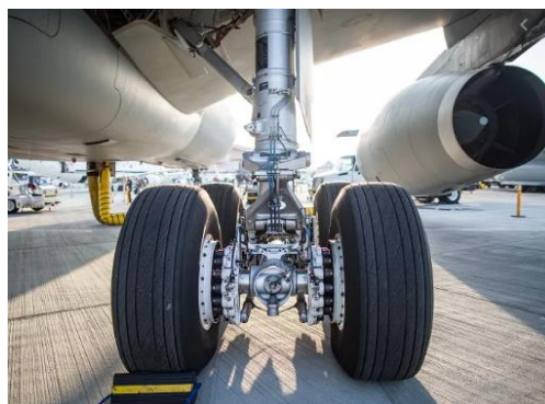
Слика 5.2: Систем за приземљавање и управљање на моделу Boeing 737 [46]
