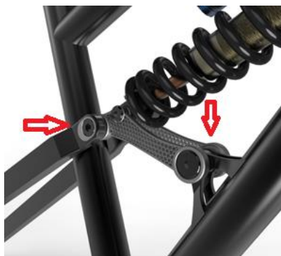
Слика 5.6: Веза система за амортизацију са рамом бицикле и виљушком точка са означеним местима уградње композитних клизних лежишта [43]
