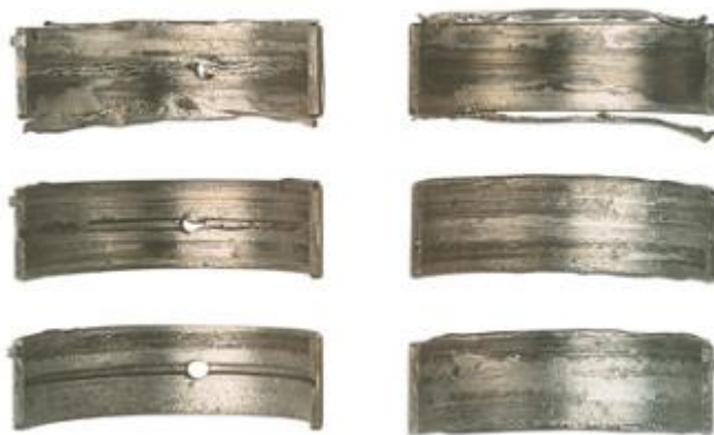
Слика 3.1: Пример оштећења при појави међусобног заваривања постељице и вратила [22]
