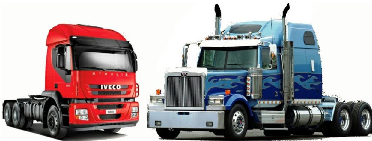
Слика 38. Међусобан положај кабине и погонског агрегата у Европи (лево) и у САД (десно) [23]
