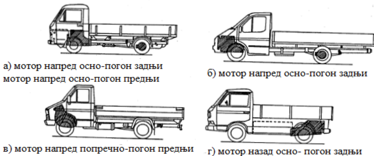
Слика 41. Положај мотора код лаких теретних возила [19]
