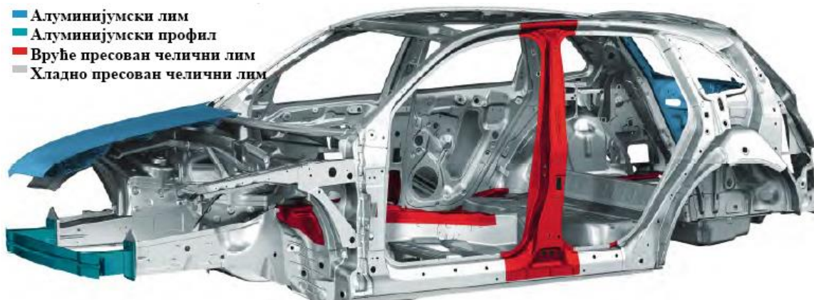
Слика 7.1. Самонесећа каросерија аутомобила (BMW X5) [20]
