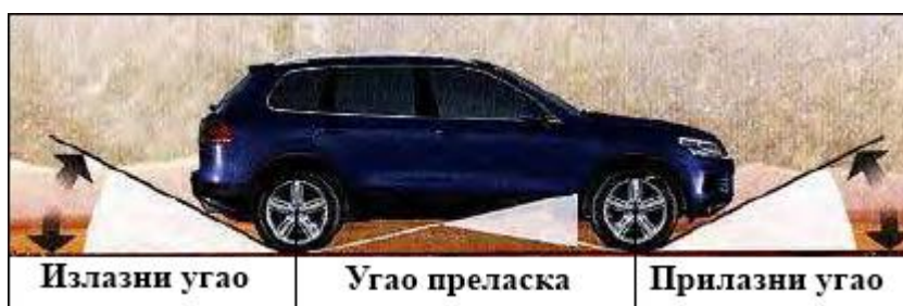
Слика 2.22. Прилазни, изразни и угао препреке [5]
