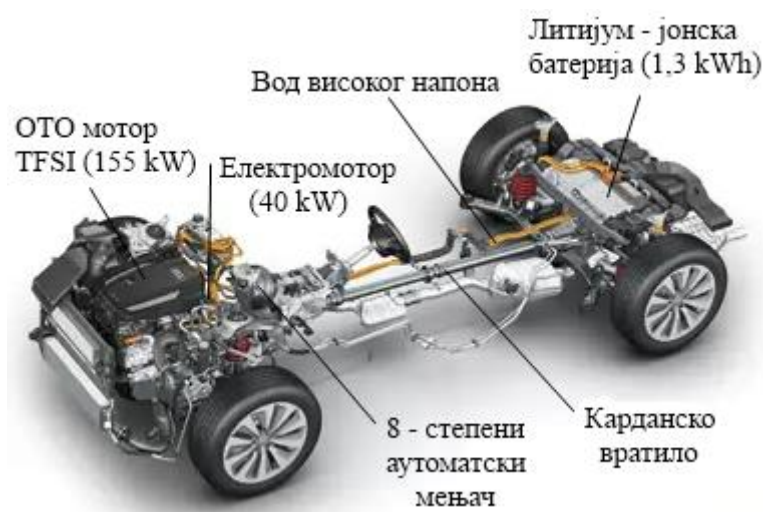
Слика 3.2. Трансмисија возила Audi Q5 Hybrid Quattro [22]
