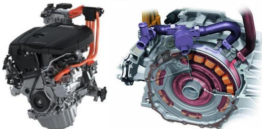
Слика 7.2. ОТО мотор код возила Audi Q5 hybrid (155 kW) и електромотор (40 kW) [22]
