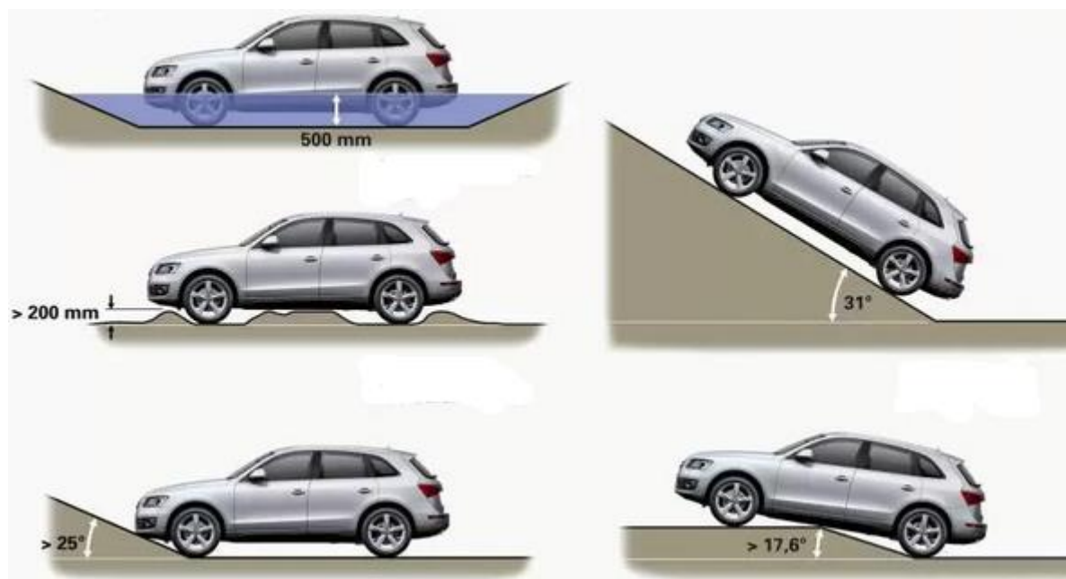
Слика 3.5. Могућност савладавања препрека возила Audi Q5 Hybrid Quattro [22]
