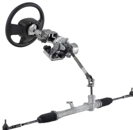
Слика 8.14. Електромеханички систем управљања ZF TRW (EPS), [40]
