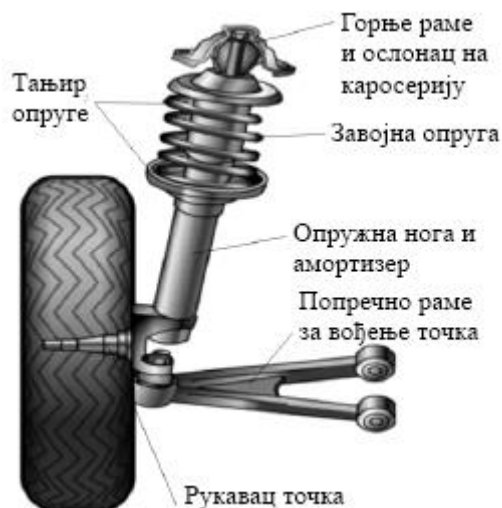
Слика 8.15. McPherson опругна нога са завојном опругом [4]
