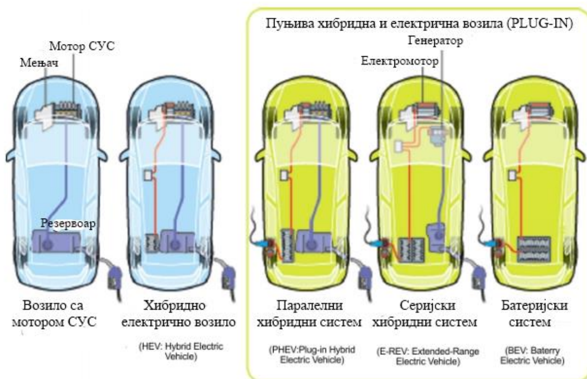
Слика 2.11. Подела путничких возила (катеорије M1) у односу на концепцију – врсту погона [12]
