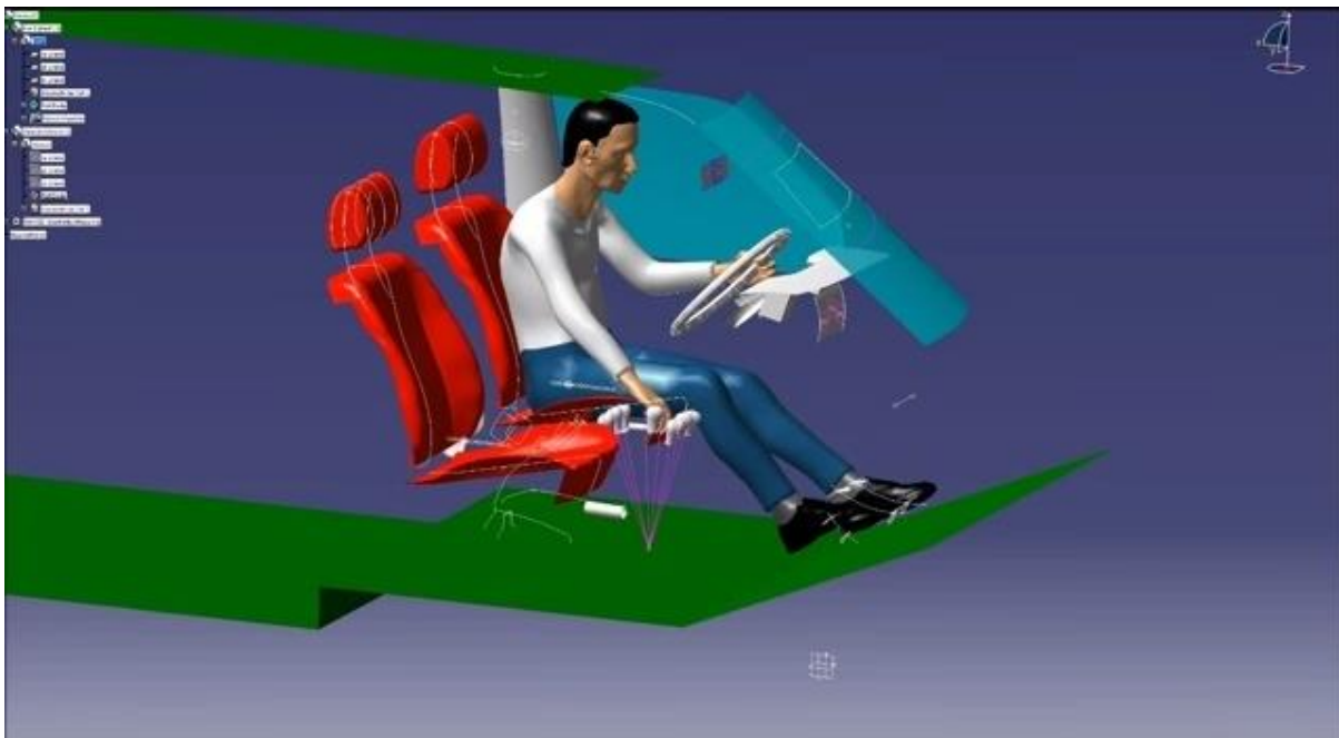
Слика 12.4. Модел возача у програмском пакету CATIA – поглед из десног угла (рука на ручици мењача)
