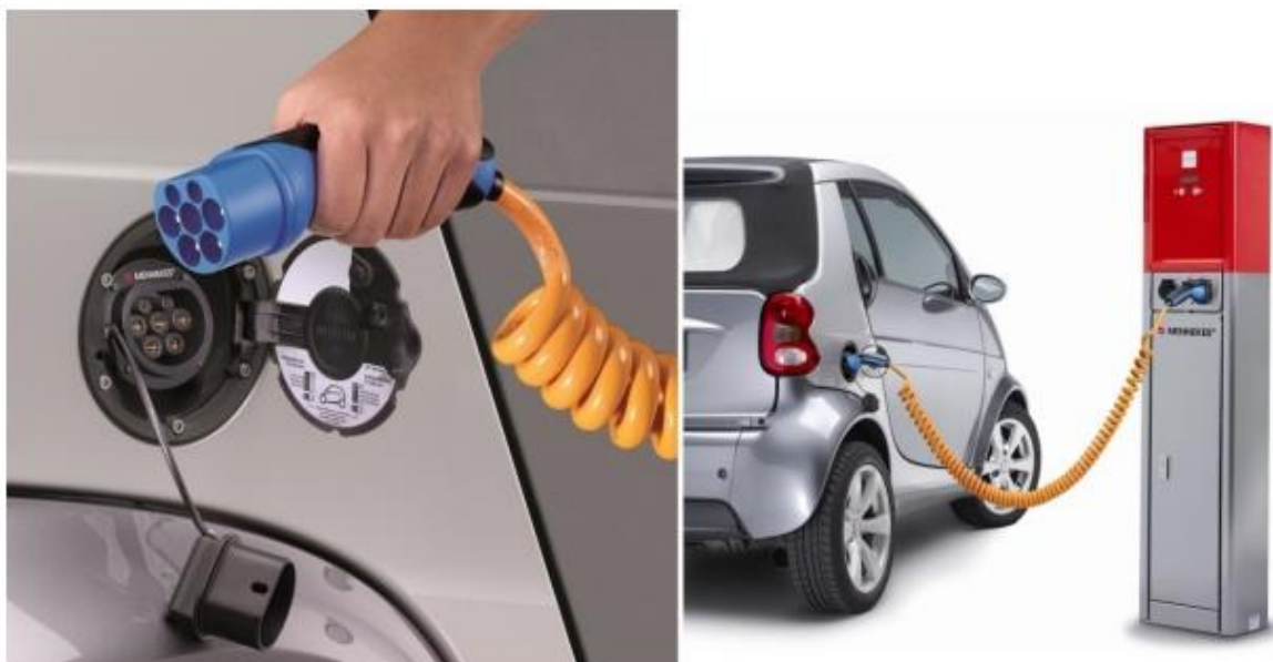
Слика 2.19. Лево – конектор за пуњење (утичница), Десно – станица за пуњење EV и PHEV возила [12]
