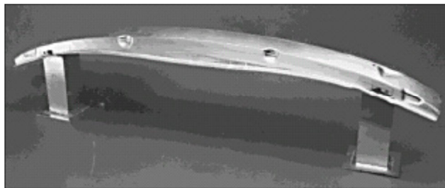
Слика 4.3. Браник аутомобила од металне пене
