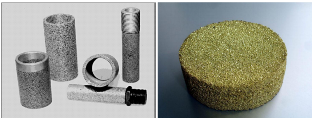
Слика 4.5. Пригушивачи звука од металних сунђера и филтери од металне пене
