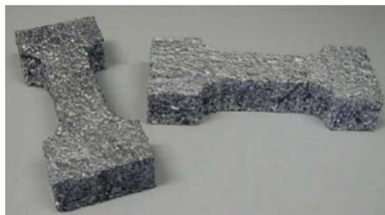
Слика 3.3. Узорци за испитивање затезне чврстоће призматичног облика са проширењем
